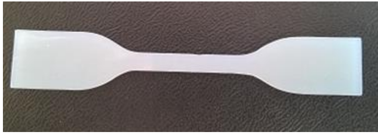
Figure 2-22 Géométrie des éprouvettes plates de traction
