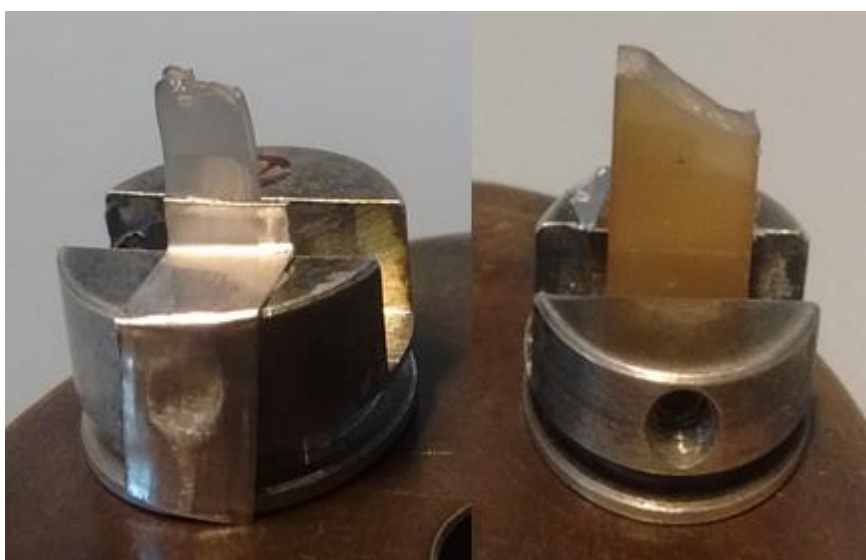
Figure 2-21 Echantillons PA11 témoin (à gauche) et vieilli H+T sec 60 jours (à droite) pour l'observation des faciès de rupture.
