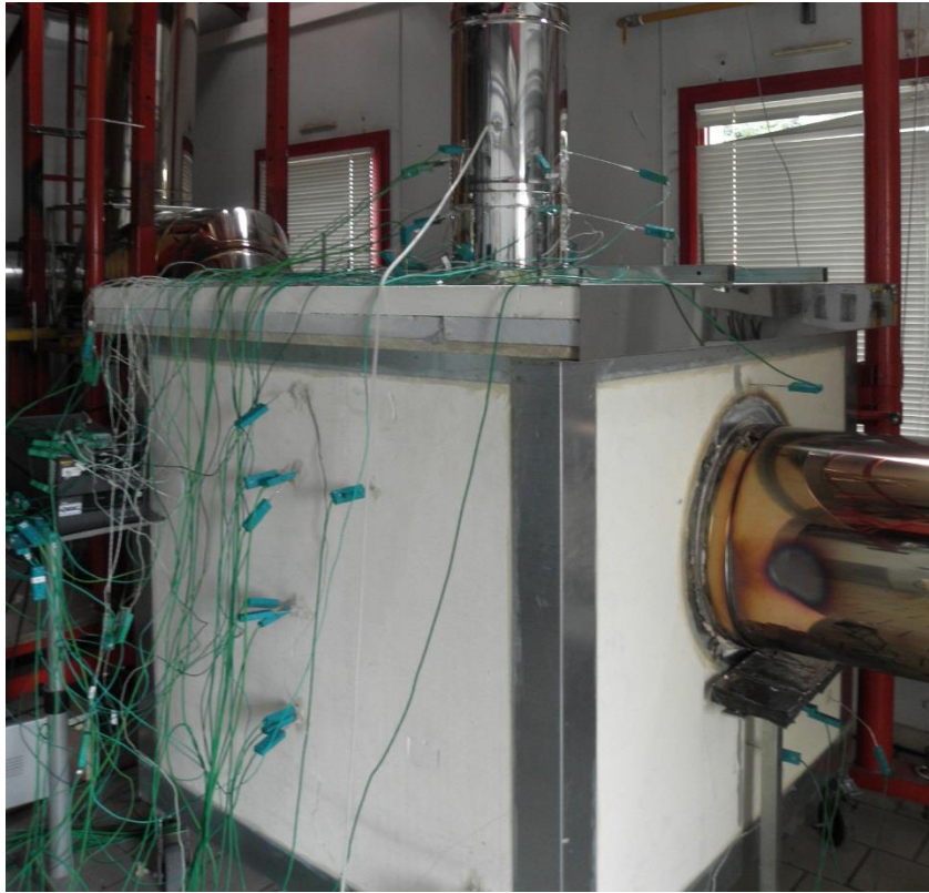
Figure A-1 : Photographie du banc de résistance au feu instrumenté
