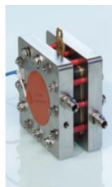
Figure 3 : schéma de l'assemblage d'une monocellule de test d'AME et photographie des différents composant et d'une monocellule complètement montée
