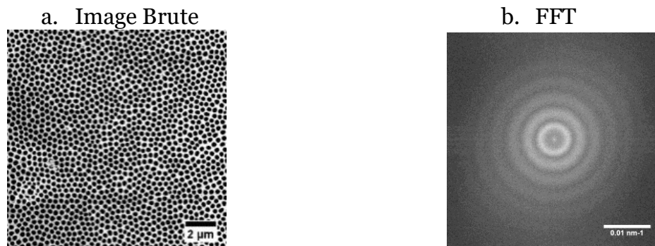
Figure 4 : image MEB présentant une grande statistique de nanopores (a) et sa transformée de Fourier associée (b)
