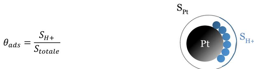
**Figure 6 : schéma du taux de couverture des H+ sur une surface d'une nanoparticule de platine**
