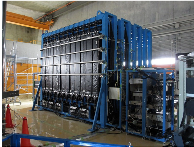
FIGURE 2.11 – Photographie du détecteur de neutrons NEBULA.
