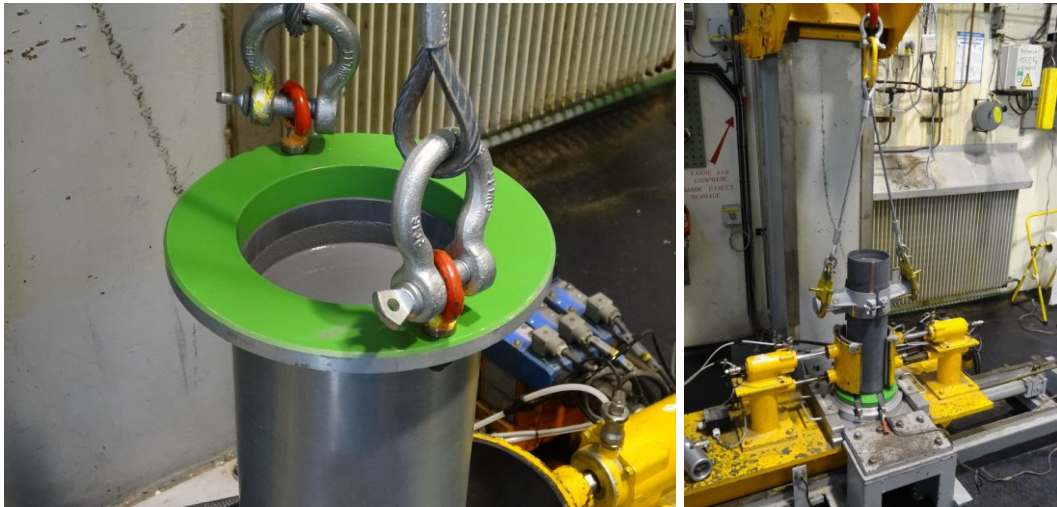
Figure 74 : Photographie de l'étape de démoulage des petits blocs
