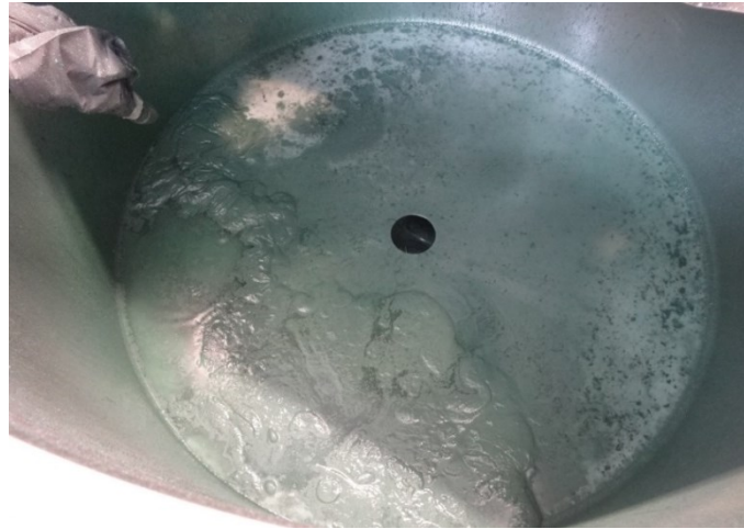
Figure 60 : Photographie de l'essai de nettoyage des cuves par hydrogommage
