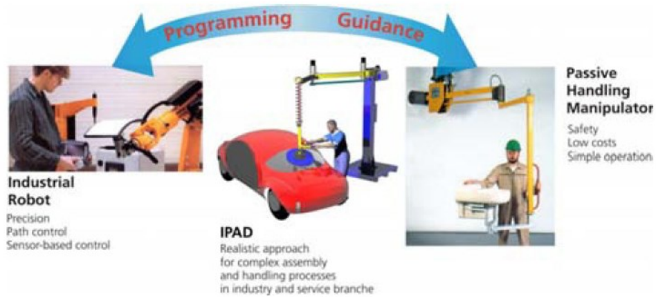
Figure 33 : Classification des systèmes hybrides entre les robots industriels et les manipulateurs passifs (Surdilovic & Schreck, 2010)
