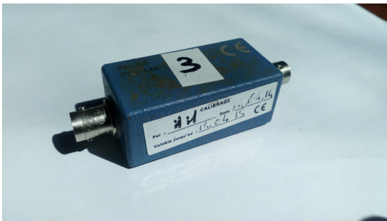
(c) Pré-amplificateur 40dB.
