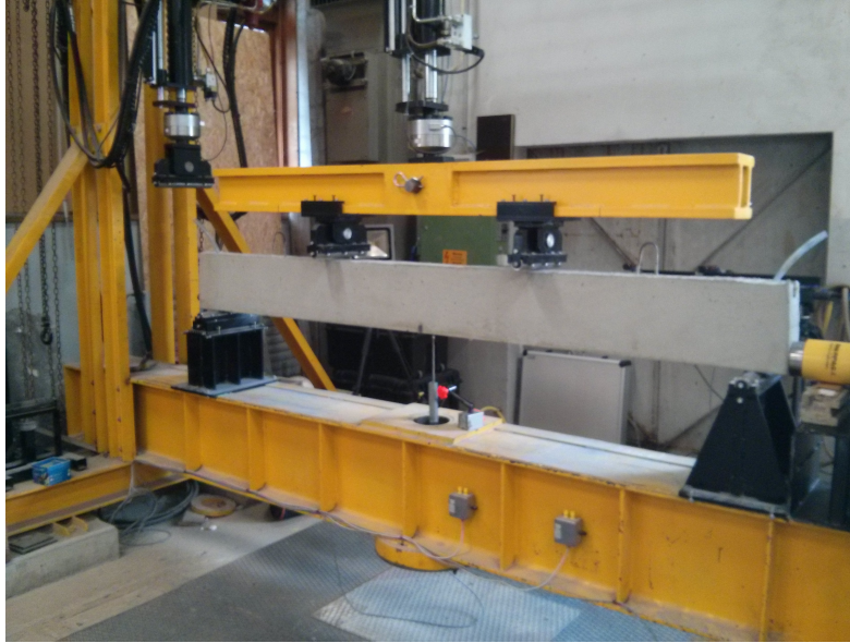
FIGURE 2.4 – Essai de flexion 4 points de refermeture de fissure.
