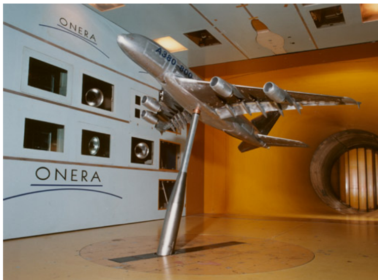
FIGURE 5.2 – Maquette d'un avion commercial dans une configuration d'atterrissage placé dans la chambre de test.
