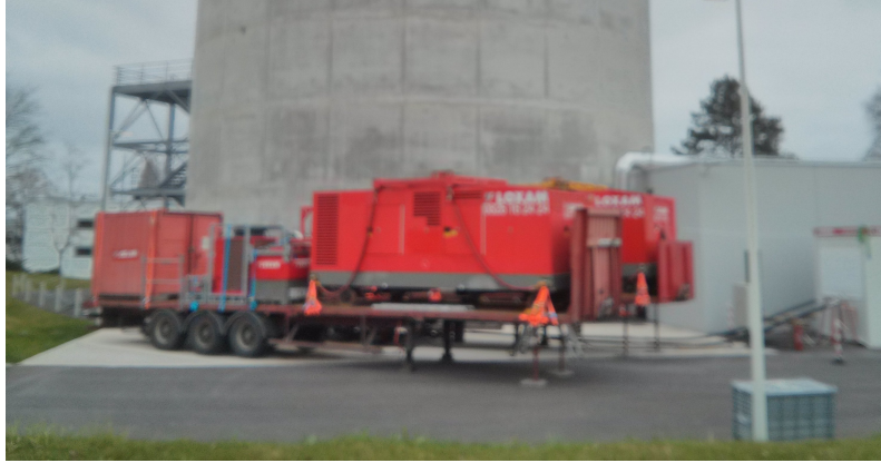
FIGURE 5.12 – Compresseurs utilisés pour la montée en pression.
