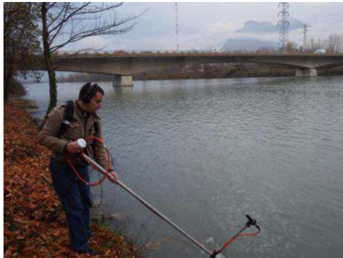
Figure A1. 5: Le système portable de mesure ponctuelle du bruit de la rivière afin de détecter le charriage (dans l'image, on est sur la rive gauche du Drac à Grenoble). On voit l'hydrophone au bout de la perche, le GPS pour la localisation de l'endroit de mesure, les casques d'écoute et le sac avec la valisette RTSyS.
