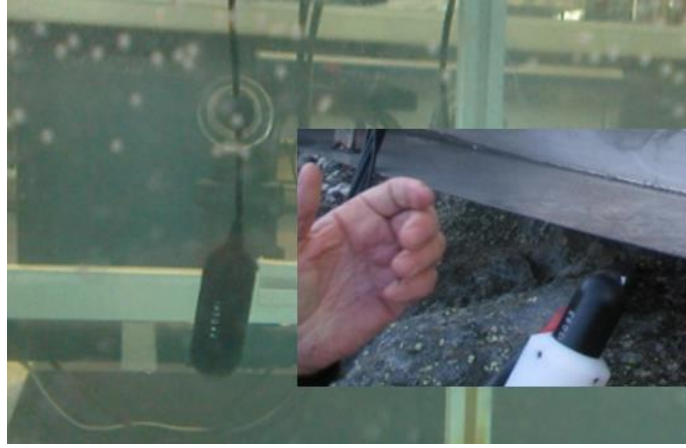
Figure 2.1 : Hydrophone utilisé pour des mesures acoustiques dans l'eau
