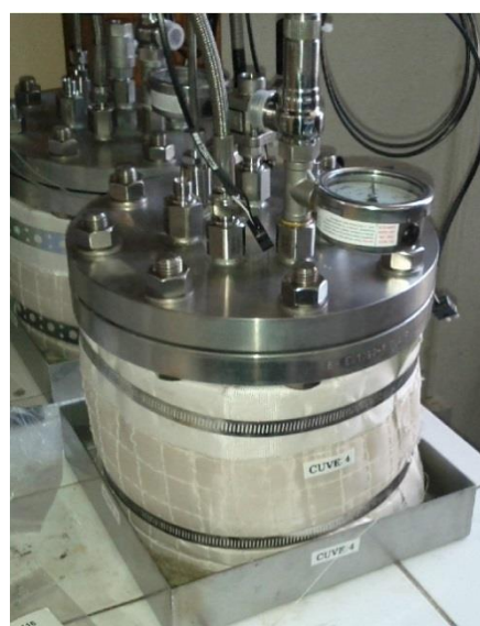
Figure 25 : (a) Le banc de compatibilité ; les quatre réacteurs et un four sous hotte aspirante (b) Une cuve : récipient métallique chauffé par une résistance enroulée autour d'elle et entourée d'isolant
