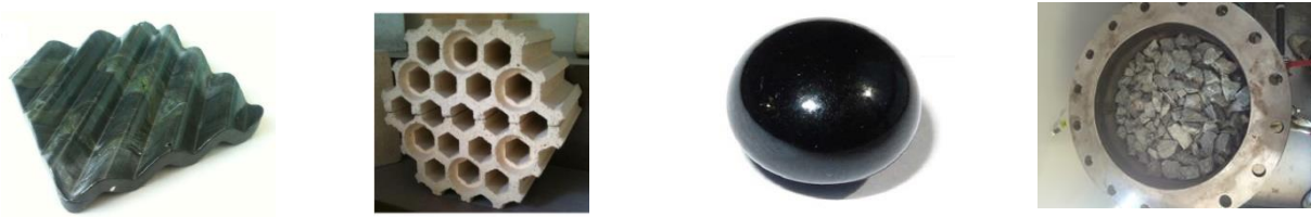
Figure 9 : De gauche à droite : matériau mis en forme de plaque ondulée, de nid d'abeille, de sphère, et matériaux de formes quelconques (roches)
