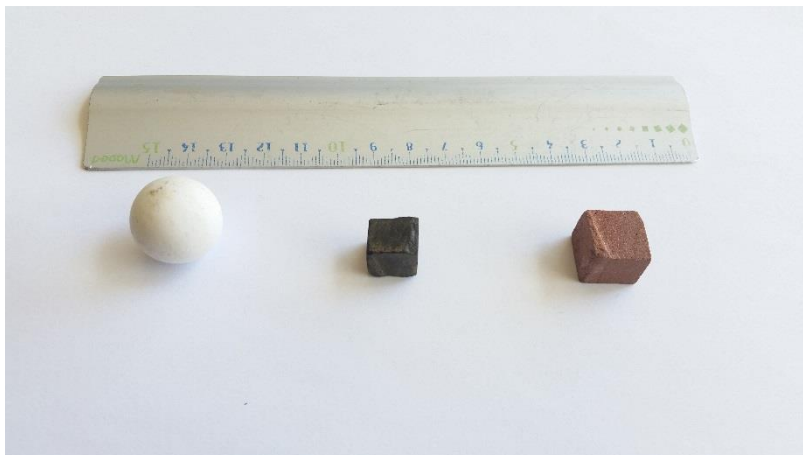
Figure 27 : Photographies des trois matériaux solides testés : de gauche à droite : une bille d'alumine, du Cofalit et des cendres volantes frittées en brique
