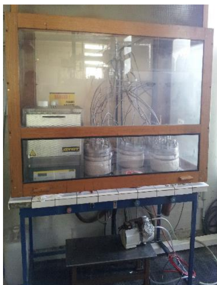
Figure 25 : (a) Le banc de compatibilité ; les quatre réacteurs et un four sous hotte aspirante (b) Une cuve : récipient métallique chauffé par une résistance enroulée autour d'elle et entourée d'isolant
