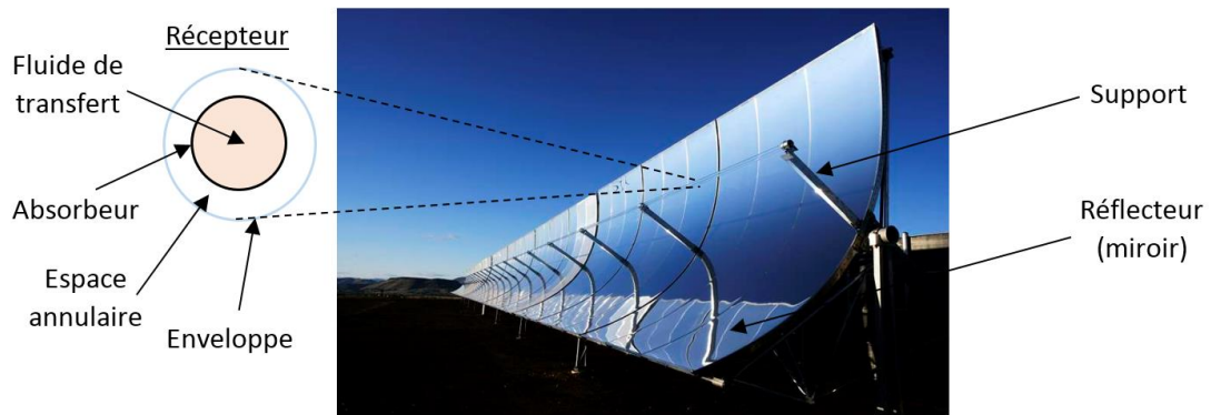
Figure 72 : Description d'un collecteur cylindro-parabolique [114]
