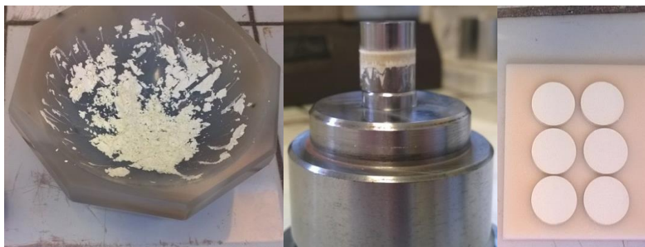
Figure 45 : a) Mélange de poudre dans un mortier, b) Poudre pastillée entre les 2 pions de la presse, c) Pastilles prêtes à être frittées
