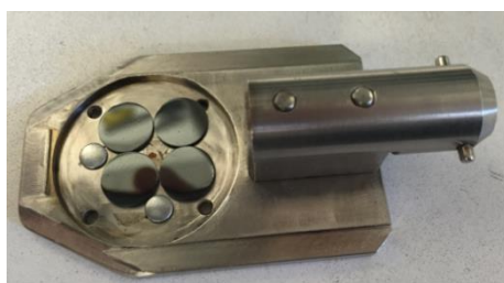
Figure 111 : 4 disques UO 2 et 2 échantillons témoins montés sur le porte-échantillon avant implantation
