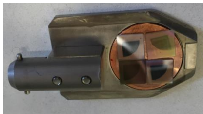
Figure 110 : 4 couches minces montées sur le porte-échantillon avant implantation
