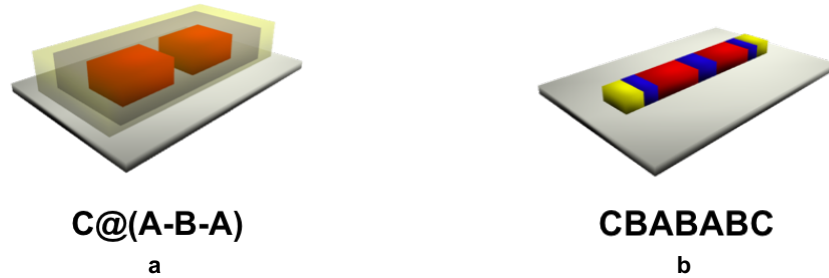
Figure 28 : Représentation schématique des zones cristallines de différentes compositions composant le cristal formé C@(A-B-A) (a) et séquence d'un tel cristal selon un axe cristallographique de croissance préférentiel CBABABC (b). Le volume rouge représente le composé cristallin A , le volume bleu le composé cristallin B et le volume jaune le composé cristallin C .
