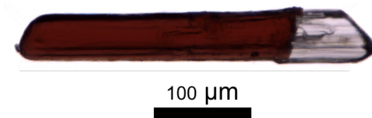
Photo 10 : Cristal FeZn formé par croissance cristalline en milieu confiné.
