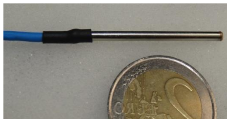
Figure III-9 : Photographie de la sonde de l'EMMP (Ducourthial 2014)
