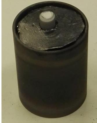
Figure 2.13 Porte-échantillon de l'enceinte BALL, avec un échantillon de  $\text{Al}_2\text{O}_3$  entamé
