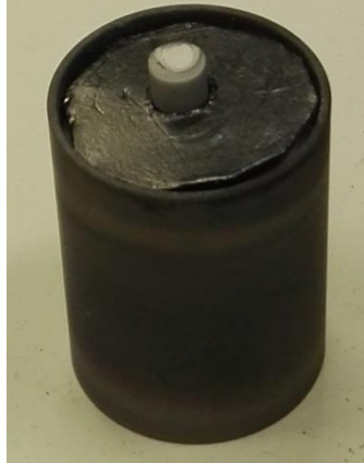
Figure 2.13 Porte-échantillon de l'enceinte BALL, avec un échantillon de Al 2 O 3 entamé
