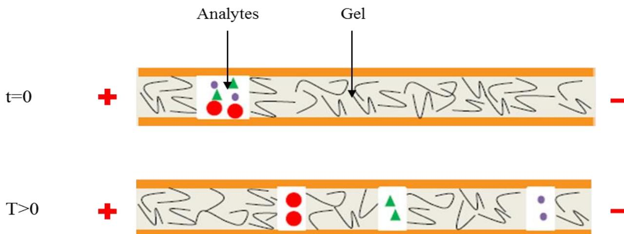
Figure 4 : Représentation schématique du principe de séparation par électrophorèse capillaire en gel
