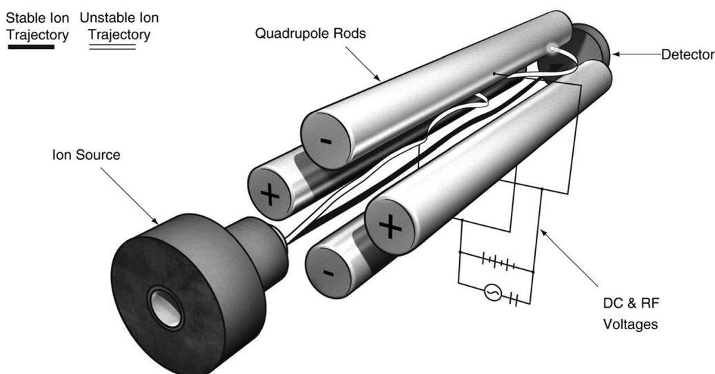
Figure 11 : Représentation schématique d'un analyseur quadripolaire<sup>80</sup>
