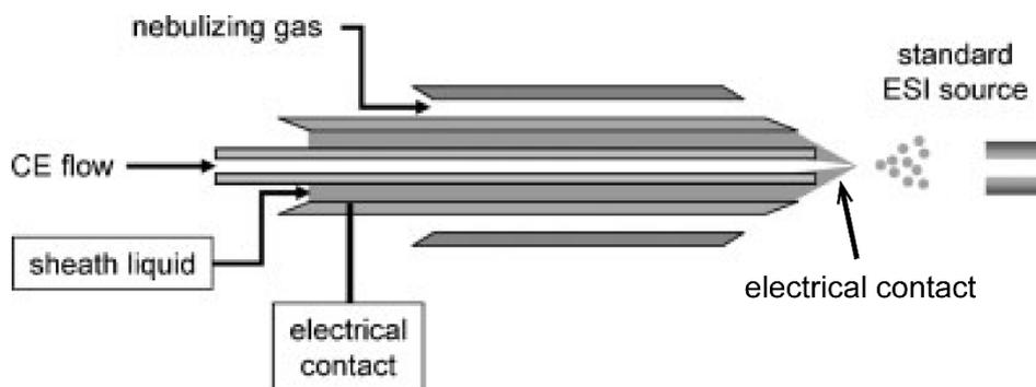
Figure 15. Représentation schématique d'un système d'interface CE-ESI-MS de type sheath-liquid. Adapté à partir de Hommerson *et al.*<sup>8</sup>
