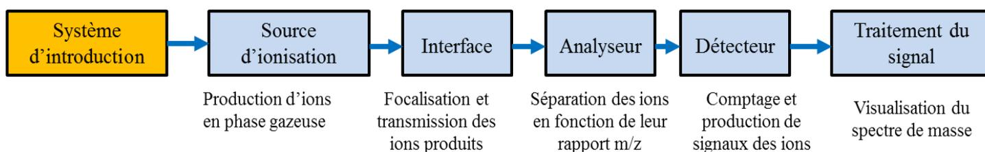
Figure 7 : Représentation schématique d'un spectromètre de masse
