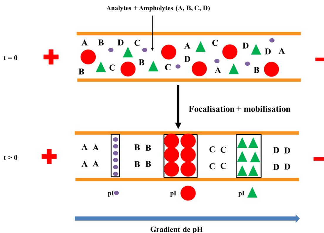
Figure 6 : Représentation schématique du principe de séparation par focalisation isoélectrique
