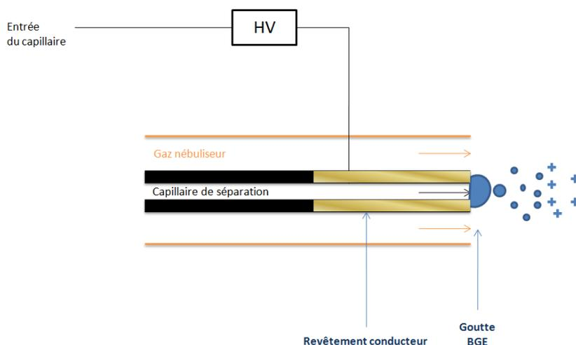
Figure 18. Interface « Sheathless » à connexion par revêtement conducteur.
