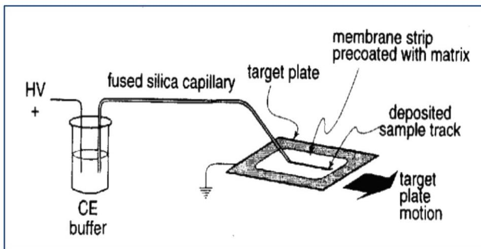
Figure 22. Reproduction du schéma de l'interface CE-MALDI-MS indirecte de la publication de Zhang 1996<sup>60</sup>
