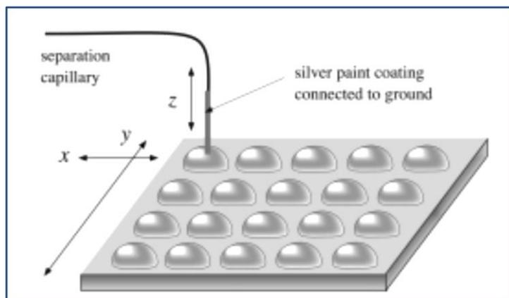
Figure 23. Reproduction du schéma de l'interface CE/MALDI-MS indirecte de la publication de Busnel 2009<sup>63</sup>.
