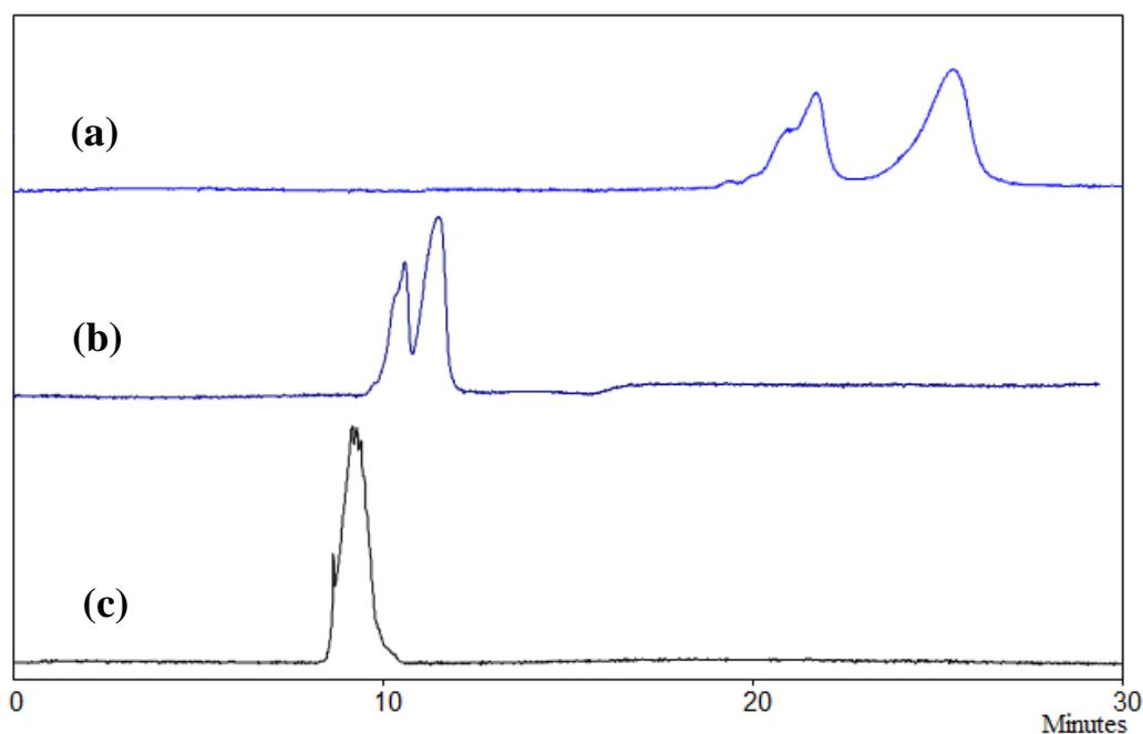
Figure 1 : Influence de l'acide formique sur la séparation middle-up du cetuximab par CE-UV
