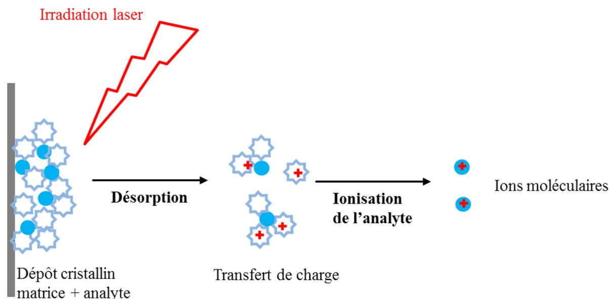
Figure 10 : Représentation schématique du principe d'ionisation MALDI
