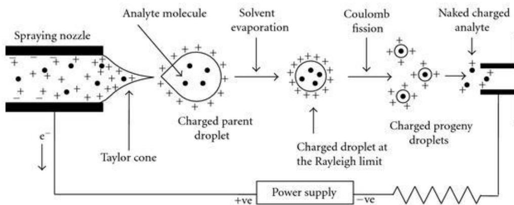
Figure 8 : Représentation schématique du principe de l'ionisation électrospray<sup>55</sup>
