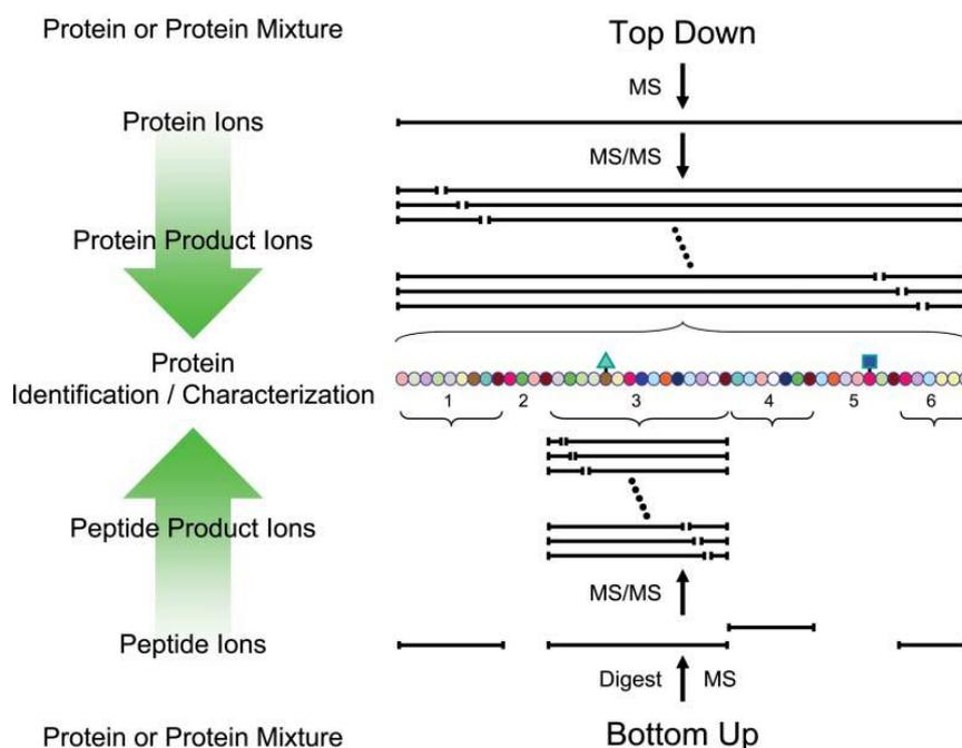
Figure 24. Représentation schématique des différentes stratégies utilisées en analyse protéomique. Extrait de la publication de Scherperel et al<sup>6</sup>.
