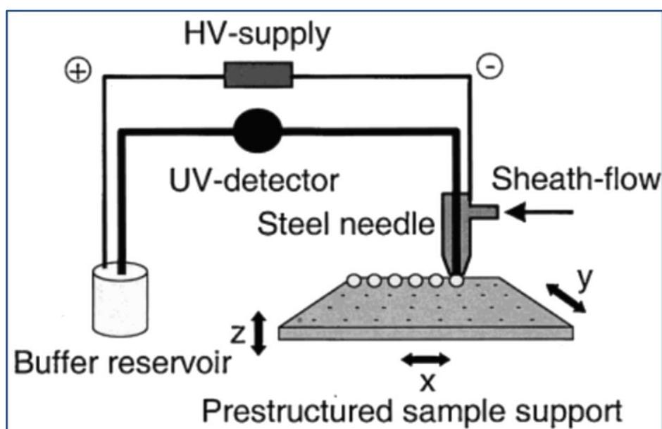
Figure 20. Reproduction du schéma de l'interface CE-MALDI-MS indirecte de la publication de Johnson 2001<sup>57</sup>.
