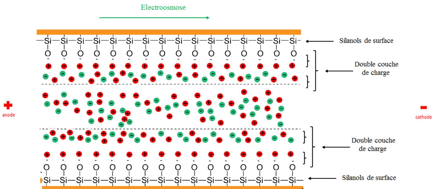
Figure 2 : Représentation schématique de la double couche dans le capillaire à l'origine de l'électroosmose
