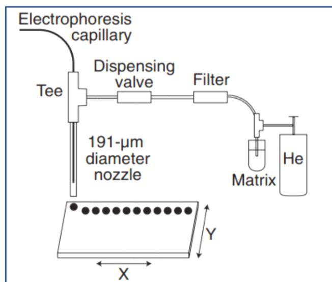
Figure 21. Reproduction du schéma de l'interface CE-MALDI-MS indirecte de la publication de Vannatta 2009<sup>59</sup>.
