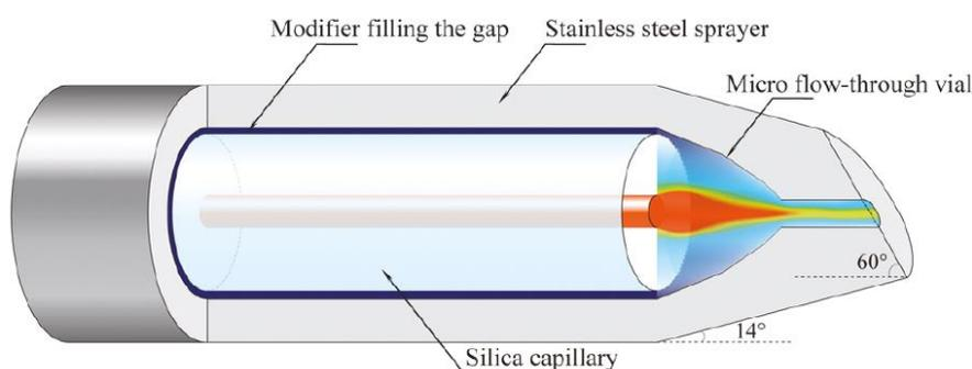
Figure 16. Représentation schématique du montage de la jonction utilisée sur l'interface CE-ESI-MS *liquid junction* à micro vial. Adapté de Maxwell et al.<sup>12</sup>.
