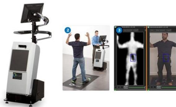
FIGURE 1.45 – Système d'imagerie passif Brijot GEN2 System [130].
