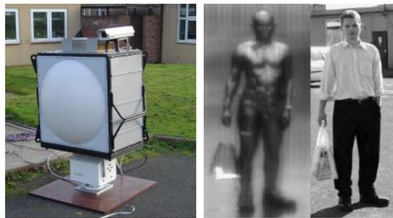
FIGURE 1.47 – Système d'imagerie Qinetiq iSPO-30 [134].
