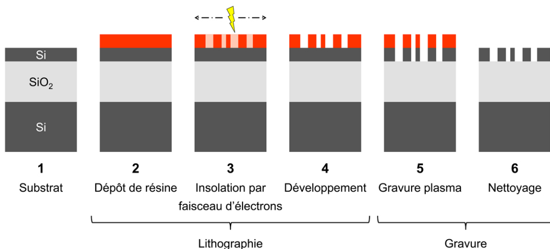
FIGURE 2.1 – Présentation des différentes étapes de fabrication des puces photoniques en SOI réalisées en salle blanche.
