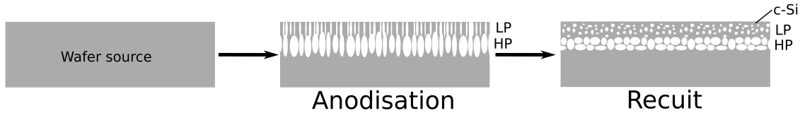
FIGURE 1.16 – Procédé de fabrication de silicium poreux pour le report de couches. L’anodisation électrochimique crée la double couche poreuse, avec une couche à faible porosité (LP) au-dessus d’une couche à forte porosité (HP). Le recuit à haute température recristallise la couche LP en surface et restructure les deux couches.
