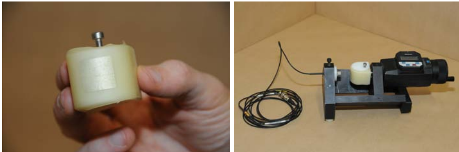
FIGURE 3.7 – Photo de la cible placée sur l'élément en plastique et de la vis micro-métrique pour l'étalonnage des capteurs sans contact radiaux.
