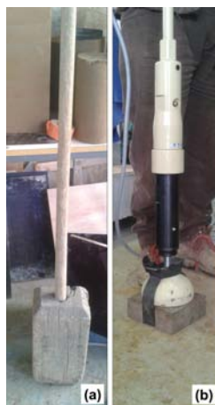
FIGURE 1.7 – (a) Dame manuelle en bois ; (b) Dame pneumatique avec un sabot en bois.
