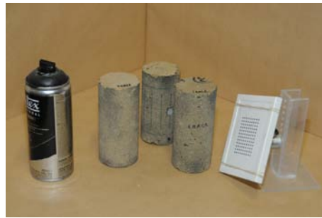
FIGURE 6.5 – Outils nécessaires au mouchetis et à la calibration pour la corrélation d'images.
