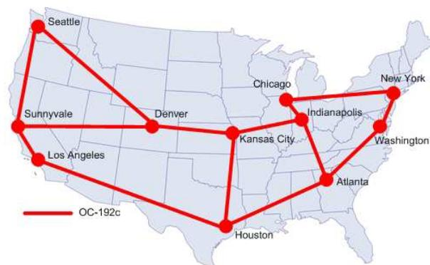
FIGURE 5.1 – Représentation de la topologie Abilene déployée au États-Unis et comprenant 11 nœuds [99]
