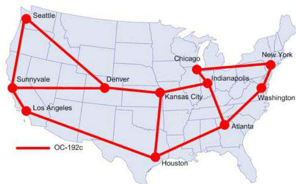
FIGURE 5.1 – Représentation de la topologie Abilene déployée au États-Unis et comprenant 11 nœuds [99]
