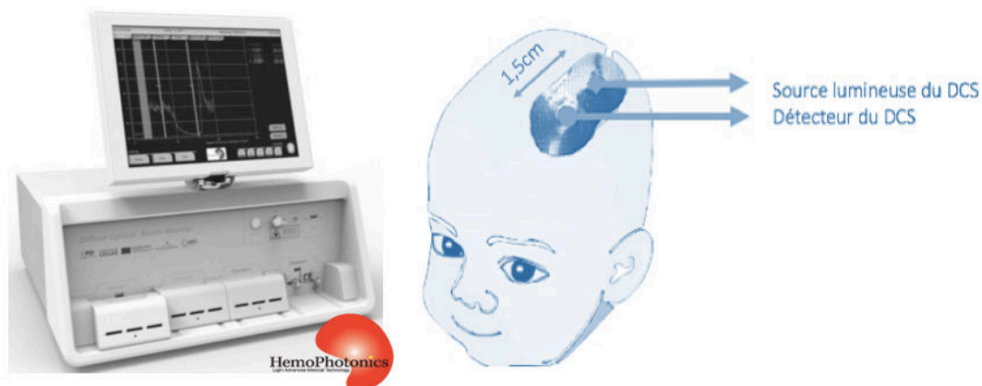
Figure 32 : Instrument DCS, Hemophotonics S.L., Barcelone, Espagne (gauche) ; et schéma du capteur DCS, adapté de Roche-Labarbe et collaborateurs, 2014 (droite)
