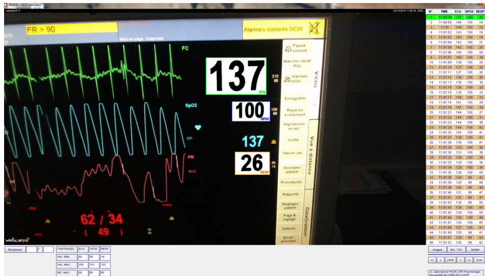
Figure 35 : Impression d'écran du logiciel de reconnaissance de caractère utilisé pour le recueil des paramètres physiologiques.
