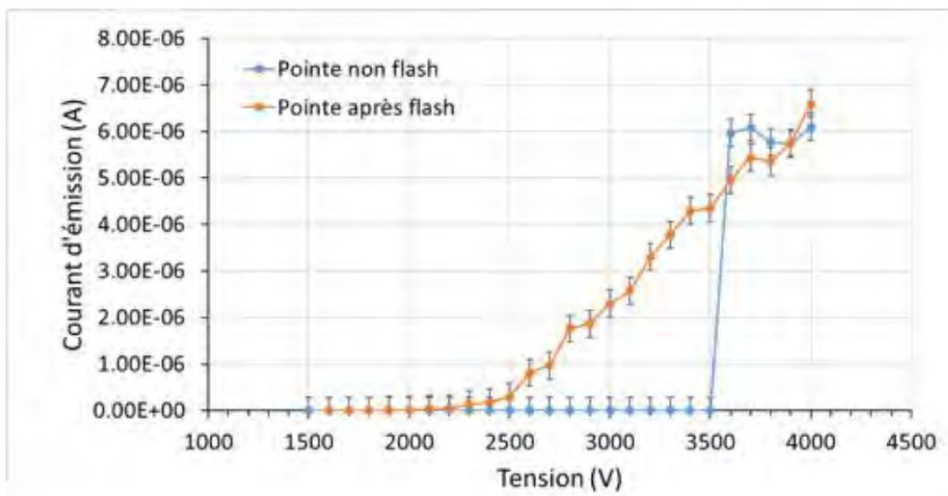
Figure 4.20 Courbes d'émission avant et après le flash.
