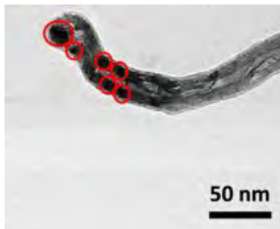
Figure 1.25 Nanotube de carbone recouvert avec du \text{LaB}_6 polycristallin (cercles rouges) [Patra et al., 2014].
