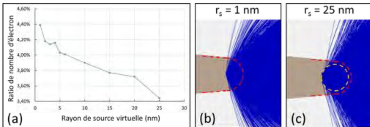
Figure 4.19 (a) Variation du ratio d'électrons de sonde en fonction du rayon de source virtuelle. (b) et (c) émission quand  $r_s$  est de 1 et 25 nm respectivement. La ligne rouge en pointillés indique la surface de l'émetteur, la ligne jaune la source virtuelle.
