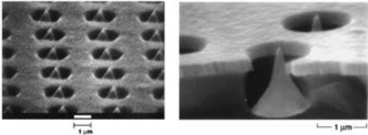
*Figure 1.17 Réseau de type Spindt pour les FED.*
