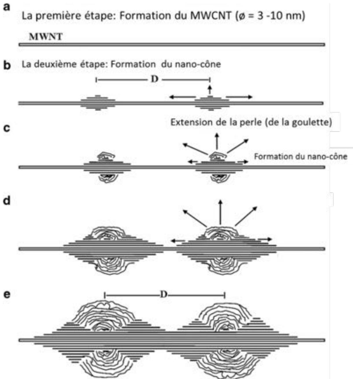
Figure 2.2 Formation du nano-cône [Monthieux et al., 2006].
