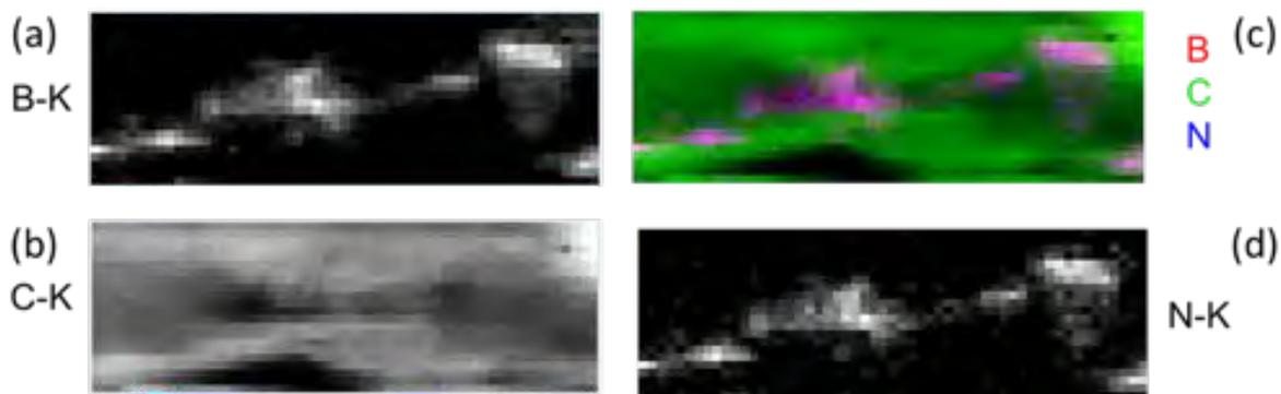
Figure 3.20 Cartes élémentaires du bore (a), du carbone (b) et de l'azote (d). (c) Carte en couleur de composition relative de B (rouge), N (bleu) et C (vert).
