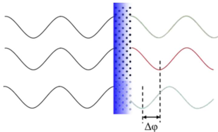
Figure 1.5 Ondes déphasées à la traversée de l'échantillon.
