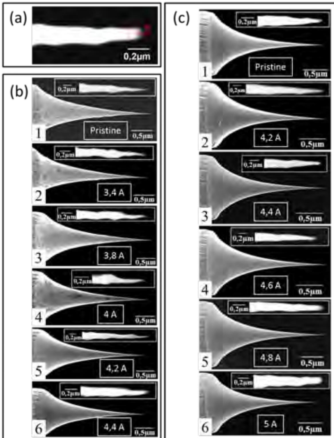
Figure 4.8 (a) Définition du rayon de courbure de l'apex. (b) et (c) pointes après le traitement de flash à différents courants
