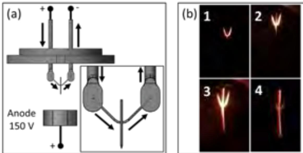
Figure 4.5(a) Configuration schématique du banc de flash. Les flèches indiquent le flux de courant dans la cathode pendant le flash. (b) Images extraites d'une vidéo de flash ( $120 \text{ fps}$ )
