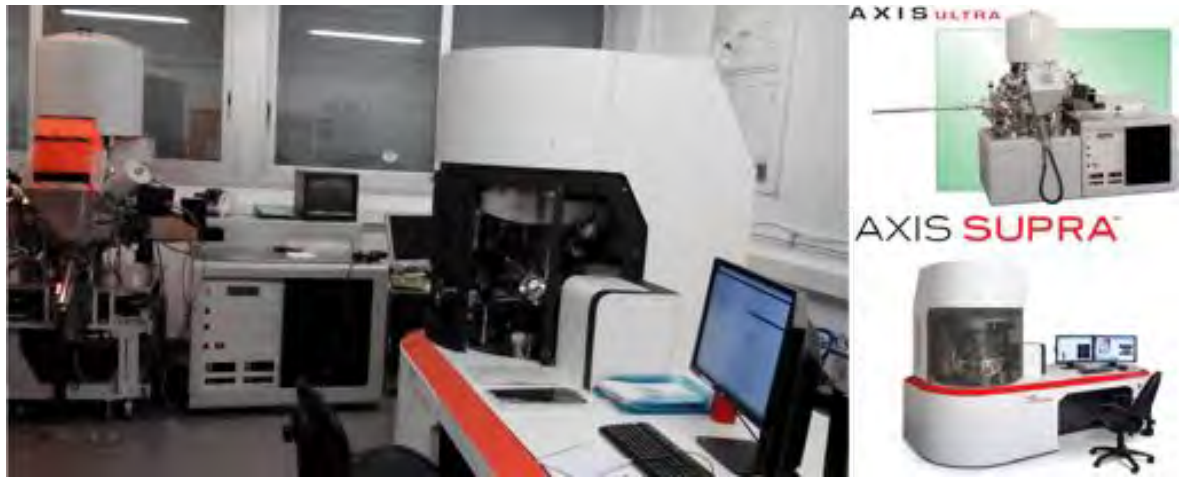
Figure 3.2 Photographies (à droite celles faites par le constructeur) des deux spectromètres XPS Kratos de l'INA-U. Zaragoza, sur lesquels ces analyses ont été développées.
