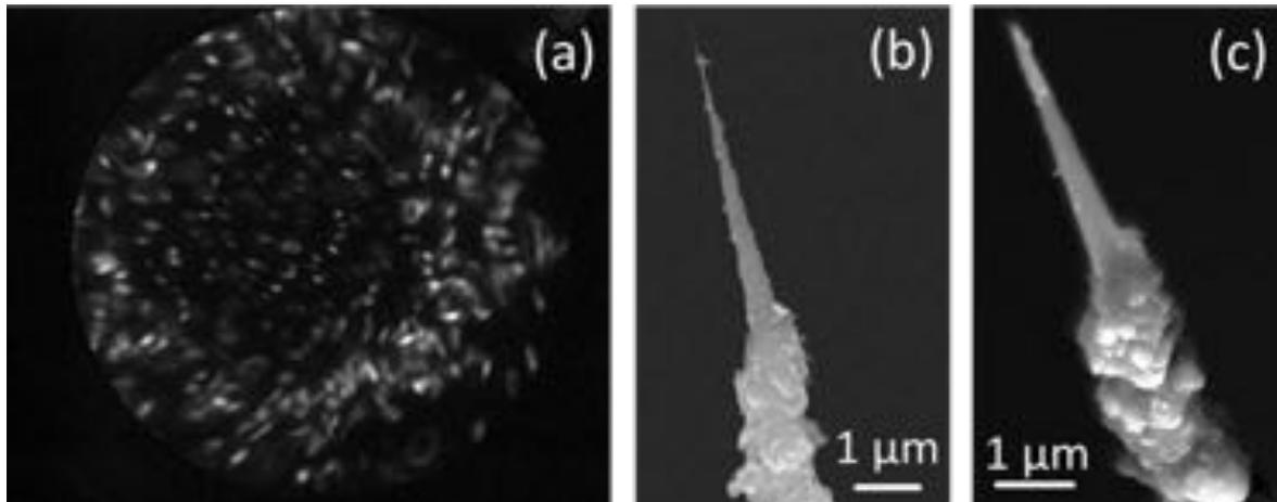
Figure 2.7 (a) Image FIM d'un CCnT. (b) et (c) sont les images MEB de ce CCnT avant et après la caractérisation par FIM.
