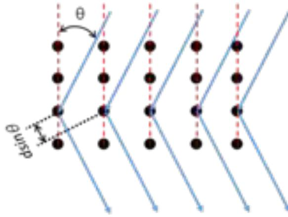
Figure 1.4 Illustration schématique de la loi de Bragg.
