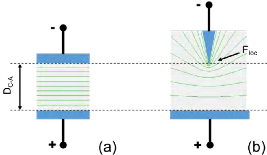
Figure 1.15 Configurations et iso-potentiels pour des électrodes planes et pour une électrode en pointe.
