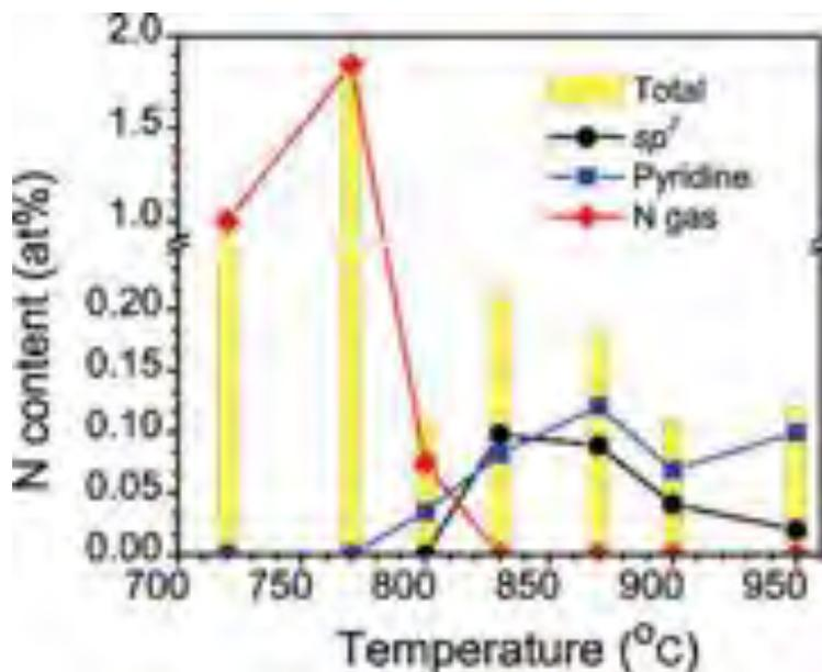
Figure 2.17 Contenu et configuration de l'azote dans des CN<sub>x</sub>-NTs en fonction de la température de synthèse [Ayala et al., 2007].
