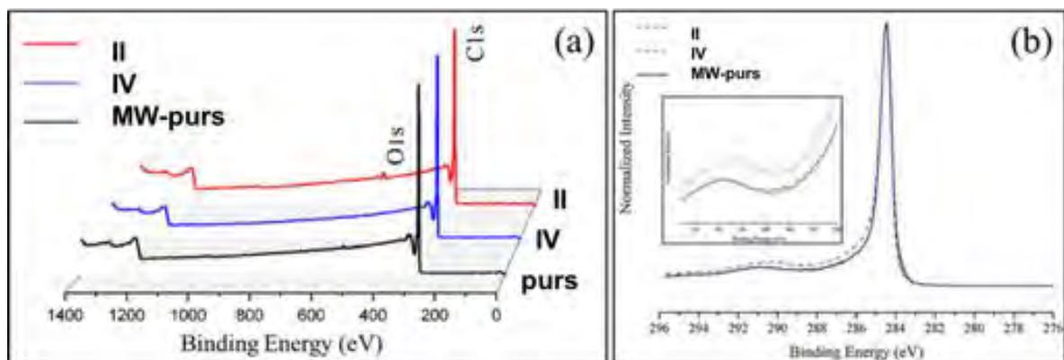
Figure 3.12 (a) Spectres XPS globaux de l'échantillon de NTs de départ (MWNT-S3100) et ceux des échantillons II et IV, respectivement. (b) Spectres C1s de ces trois échantillons.
