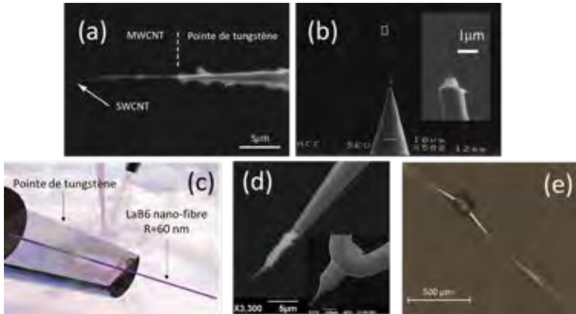
Figure 2.4 Différentes pointes émettrices : (a) SWCNT [Nakahara et al., 2009], (b) MWNT [Chai et al., 2005], (c) fibre de LaB<sub>6</sub> [Zhang et al., 2016], et (d) nano-cône de carbone (CCnT) [Houdellier et al., 2012]. (e) Les nano-cônes de carbone vus dans un microscope optique.
