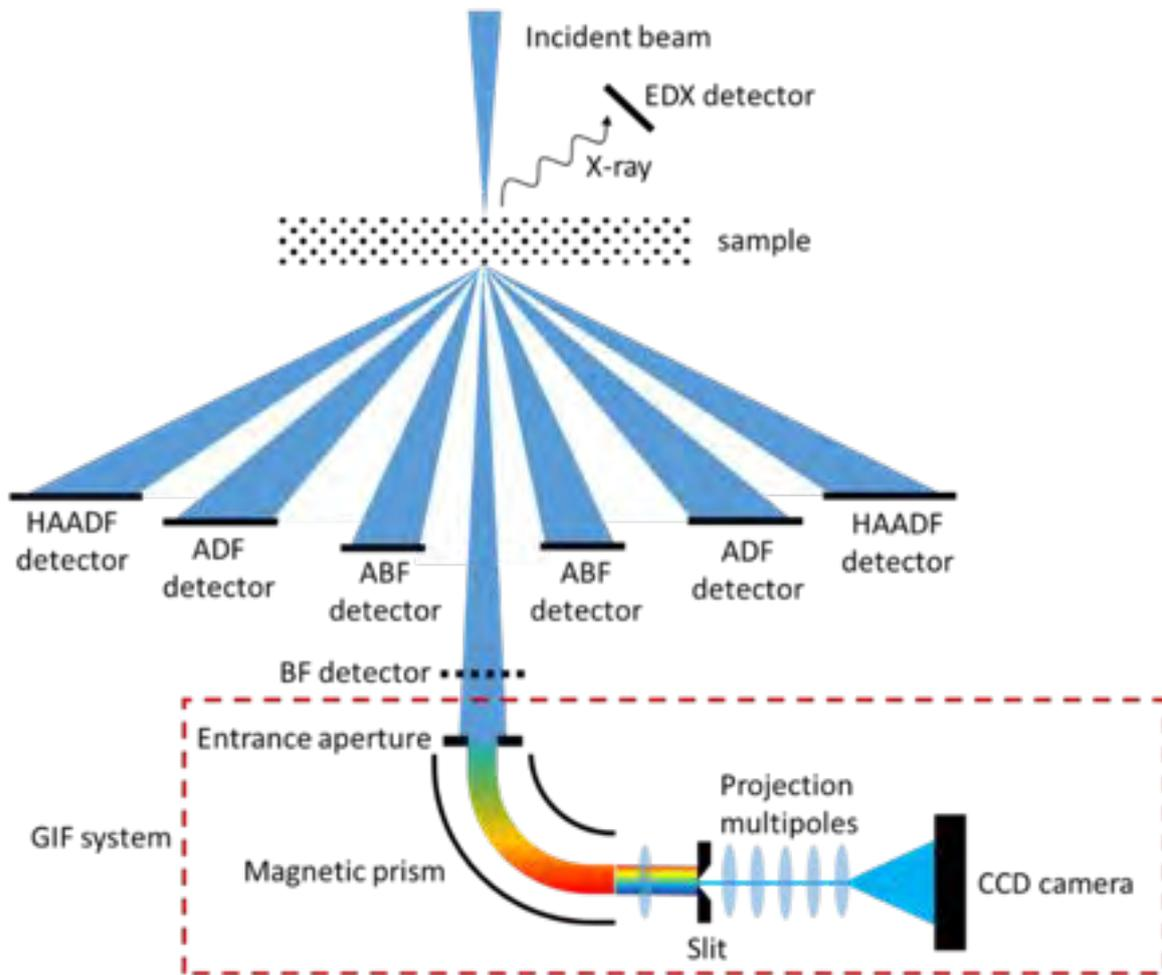
Figure 1.11 Les positions des détecteurs utilisés et le système du GIF dans un STEM.
