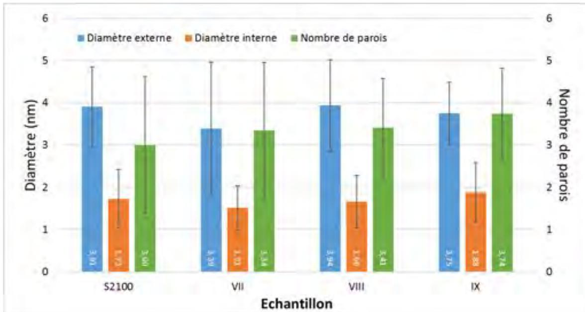
Figure 3.9 Etude statistique (basée sur >50 NTs) en considérant 3 paramètres : diamètre extérieur (D), nombre de parois (n) et diamètre intérieur (d) pour la sélection d'échantillons des FWNTs ayant subi le traitement carbothermique (voir tableau 3.1).
