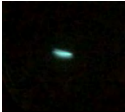
Figure 1.31 Faisceau d'électron apparaissant sur la MCP en réponse au champ magnétique d'un aimant permanent. Ce faisceau est déformé par le champ de fuite non homogène de l'aimant.
