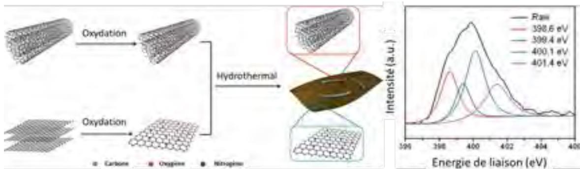
Figure 2.23 Schémas montrant la procédure de synthèse de  $CN_x$ -NT et N-Graphène par la voie hydrothermale. A droite, un spectre XPS  $N1s$  enregistré sur l'échantillon [Chen et al., 2013].
