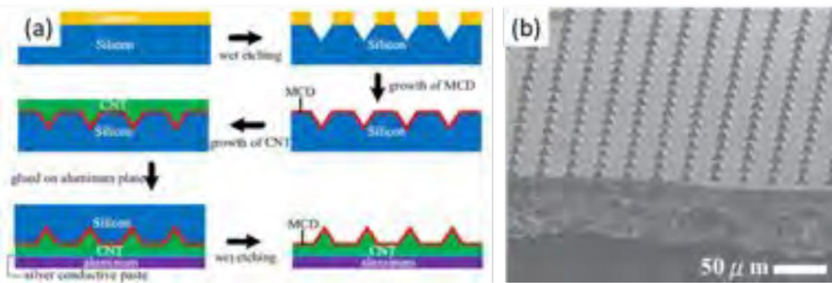
Figure 1.19 Schéma des étapes de fabrication d'un réseau de pyramides de diamant microcristallin (a) ainsi que l'image MEB (b) [Tsai, Tsai, 2015].
