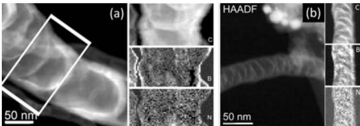
Figure 2.19  $B_xC_yN_x$ -NTs obtenus respectivement par la voie de CVD (a) et la voie de vaporisation laser (b). Les images marquées C, B et N sont respectivement les cartes élémentaires de C, B et N [Enouz-Védrenne et al., 2008].
