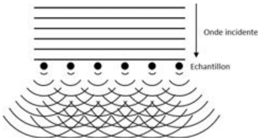
*Figure 1.7 Illustration schématique de l'interférence entre les ondes secondaires émises par l'échantillon.*
