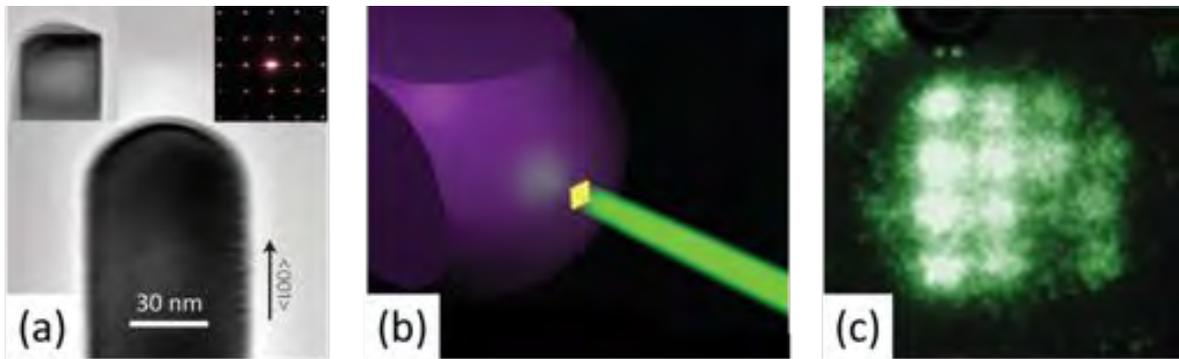
Figure 1.24 (a) Une image MET de l'émetteur de  $\text{LaB}_6$  avec une extrémité demi-sphérique, l'insert à gauche est le nanofil avant sa mise en forme en émetteur, l'insert de droite est la diffraction du nanofil de  $\text{LaB}_6$ . (b) Une image schématique de l'émission de champ par la pointe. (c) Le motif de l'aire d'émission observé par FEM [Zhang et al., 2016].
