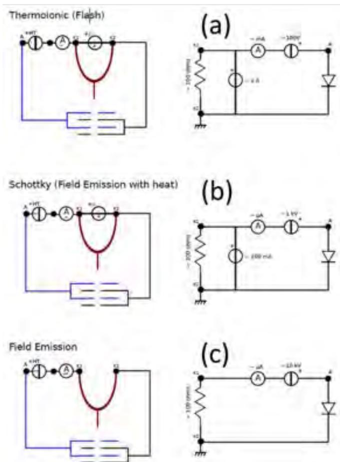
Figure 1.28 Trois configurations électroniques différentes pour le canon.
