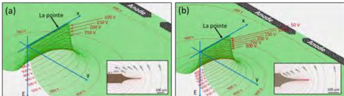
Figure 4.15 Modèle de l'anode extractrice (AI) et la pointe réalisée dans SIMION. La différence de potentiel entre les électrodes est de 700 V (a) et 1000 V (b) respectivement. Les inserts montrent la distribution du potentiel en 2D près de la pointe.
