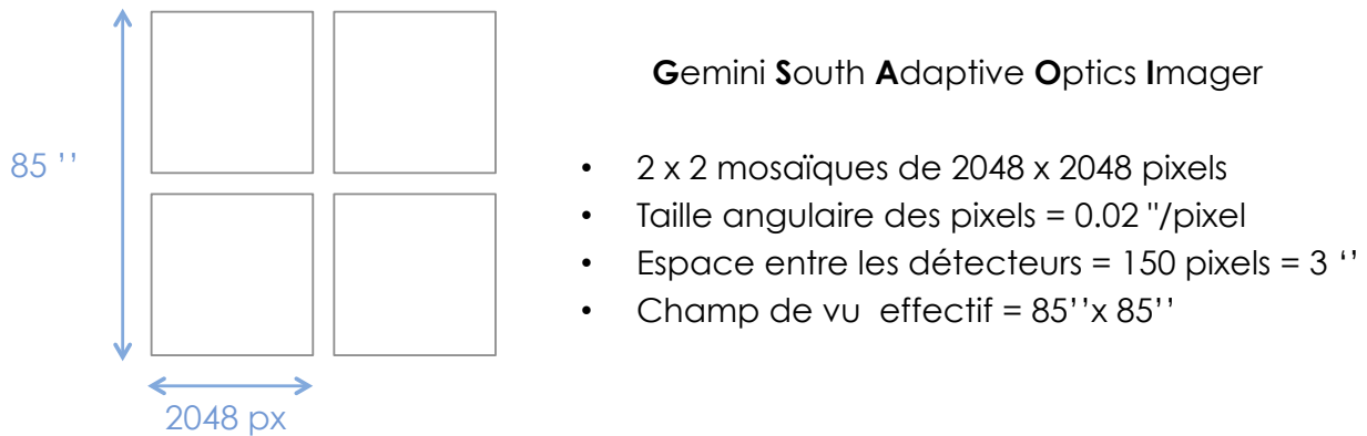
Figure 1.19 – Caractéristiques des détecteurs de la camera IR GSAOI.
