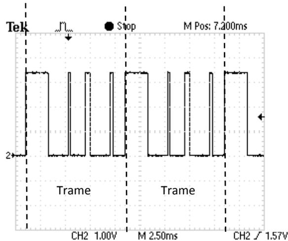
Figure V-16 : Exemple de trame générée par le programme d'émission pour une fréquence de 4 kHz
