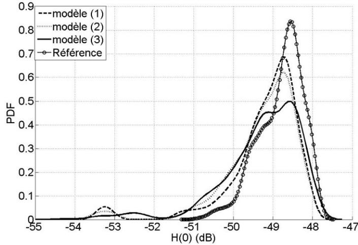
Figure III-19 : PDF du gain pour différents modèles de corps avec un coefficient de réflexion  $\rho_1 = 0.7$
