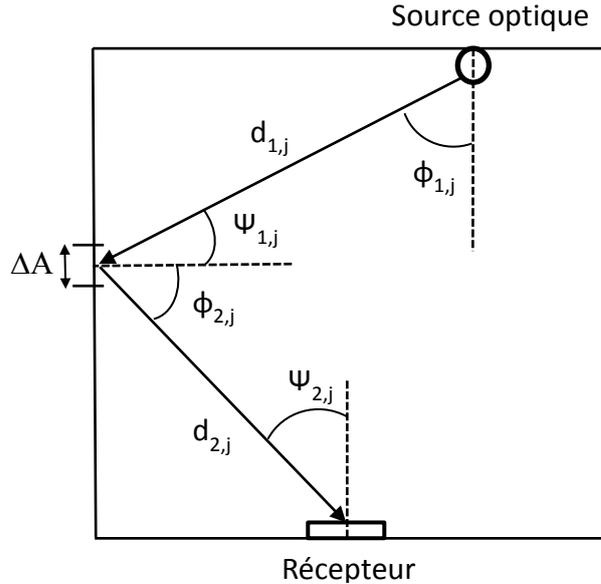
Figure II-16 : Illustration d'un lien optique à une réflexion entre un émetteur et un récepteur
