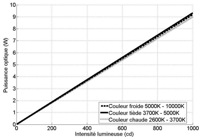
Figure II-9 : Evolution de la puissance optique en fonction du flux lumineux pour les trois profils de température
