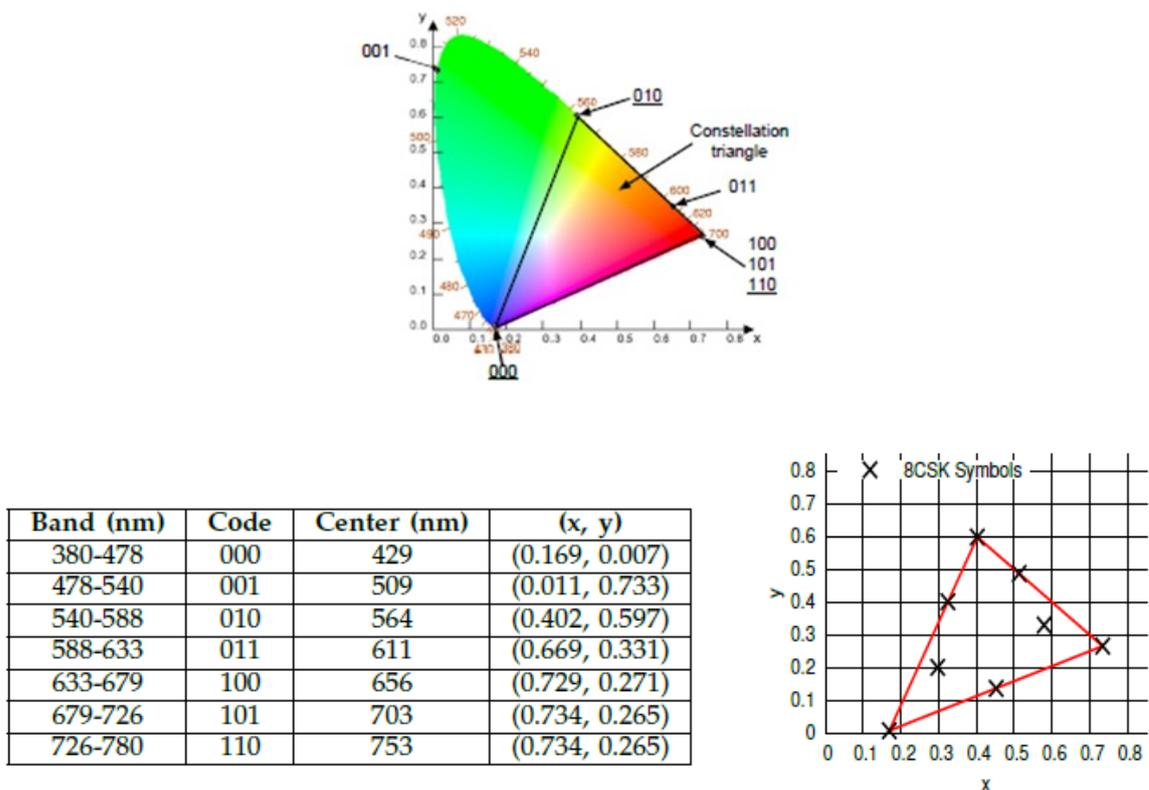
Figure II-20 : Exemple d'une modulation CSK avec 8 symboles
