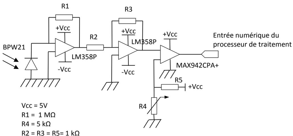
Figure V-18 : Schéma électrique de la réception
