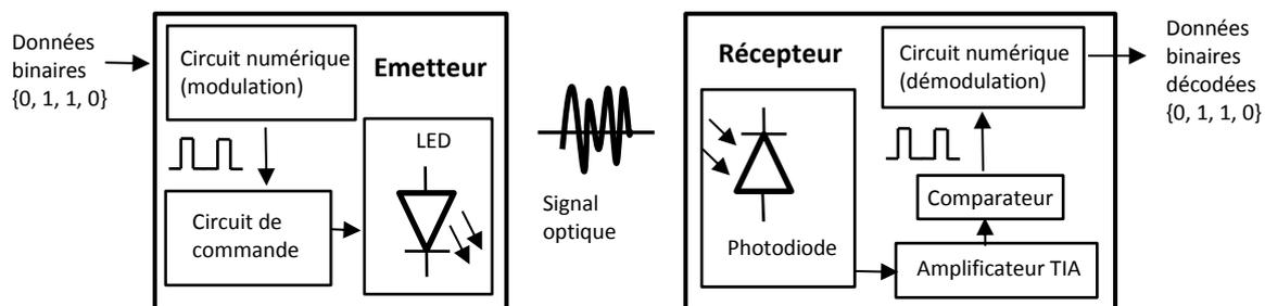
Figure V-12 : Schéma de fonctionnement du prototype VLC réalisé
