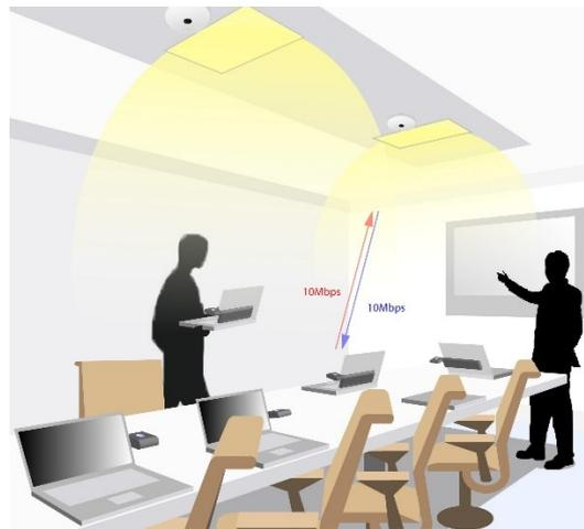
Figure I-6 : Exemple d'une configuration VLC point à point
