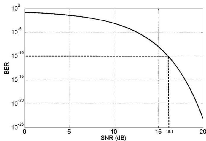
Figure IV-2 : Evolution du BER en fonction du SNR pour une modulation OOK
