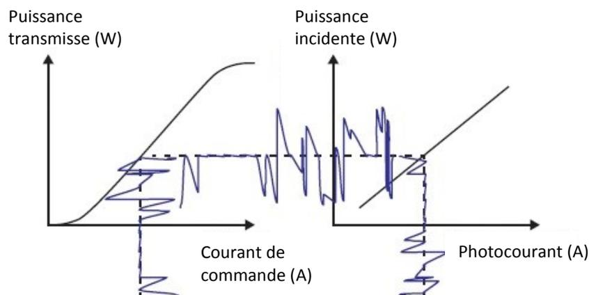
Figure II-1 : Fonctionnement IM/DD [82]
