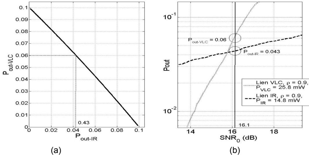
Figure IV-18 : (a) Valeurs des couples ( $P_{out-VLC}$  ;  $P_{out-IR}$ ) permettant de respecter une  $P_{out-globale} = 10\%$ , (b) Exemple d'un couple ( $P_{out-VLC}$  ;  $P_{out-IR}$ ) permettant de respecter  $P_{out-globale} = 10\%$  pour  $SNR_0 = 16.1$  dB
