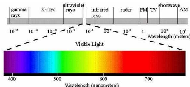
Figure I-1 : Spectre optique de l'ultraviolet à l'infrarouge
