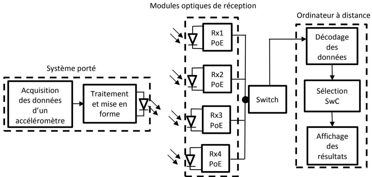
Figure V-2 : Schéma de principe du système expérimental IR
