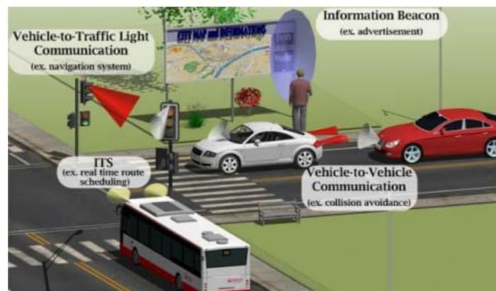
Figure I-5 : Illustration des applications VLC en extérieur
