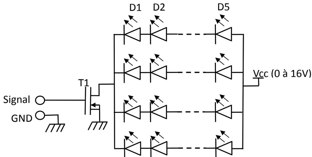
Figure V-13 : Schéma électrique de la partie émission du banc VLC
