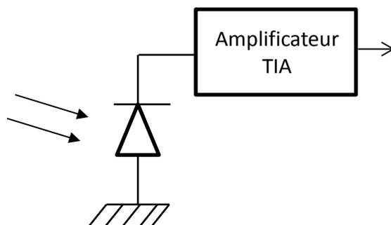
Figure V-17 : Schéma de la conversion courant/tension
