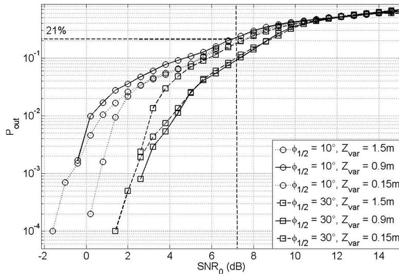
Figure V-9 : Probabilité de rupture pour  $\phi_{1/2} = 30^\circ$  et  $10^\circ$  en considérant plusieurs hauteurs  $Z_{var} = 0.15m, 0.8m$  et  $1.5m$
