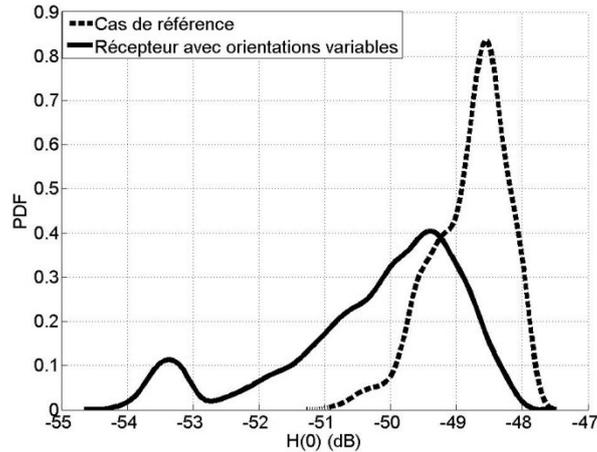
Figure III-16 : PDF des gains associés aux cas de référence et à celui d'un récepteur mobile avec changement d'orientations
