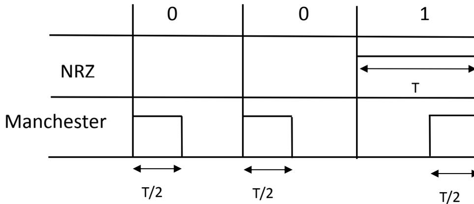
Figure II-18 : Comparaison des codes Manchester et NRZ
