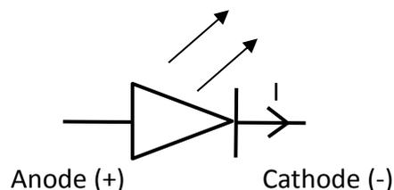
Figure II-2 : Représentation standard d'un composant LED
