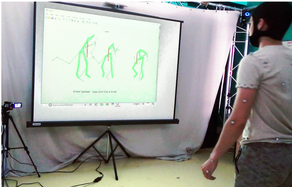
FIGURE 5.10 – Session d'entraînement d'un novice avec Optitrack ® . 37 marqueurs sont positionnés sur le novice, 8 caméras extraient leurs positionnements en 3D. L'interface d'entraînement est projetée au novice lors de sa session.
