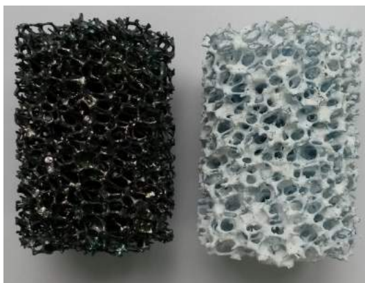
Figure 45 – Mousses en carbure de silicium avant/après enrobage par le \text{TiO}_2 selon la méthode dip-coating (5 trempes).
