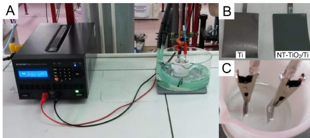
Figure 76 – A) Dispositif électrochimique pour la synthèse des nanotubes de \text{TiO}_2/\text{Ti} , B) électrode avant/après synthèse et C) photo de l'intérieur du béccher en téflon avec les électrodes de Ti et Pt.
