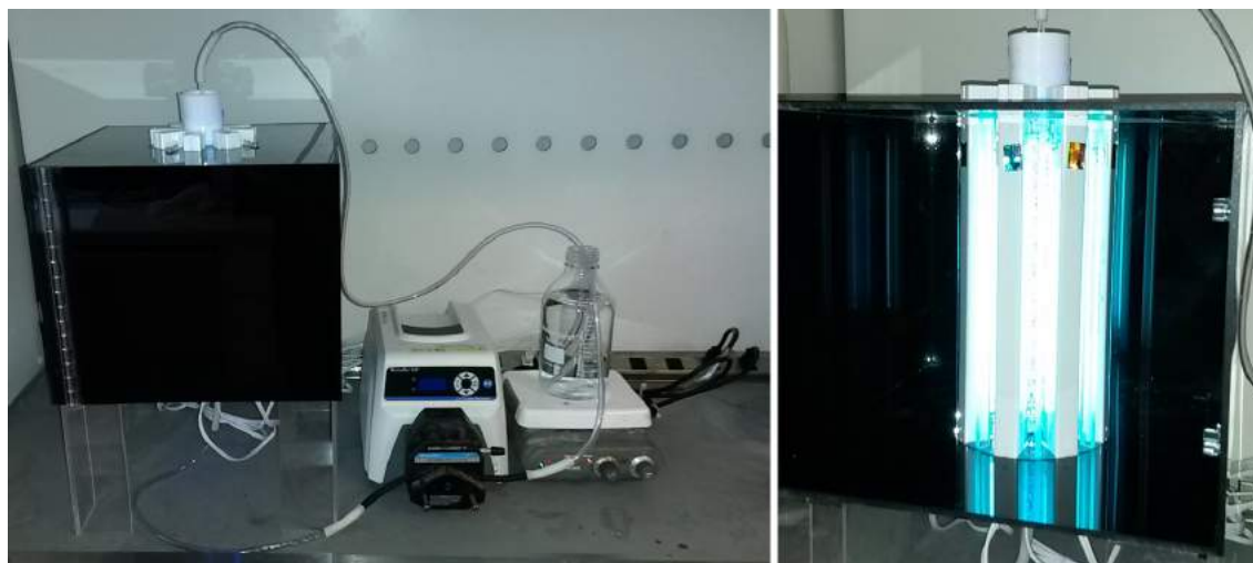
Figure 47 – Photos du réacteur photocatalytique intégrant des mousses \text{TiO}_2/\text{SiC} .
