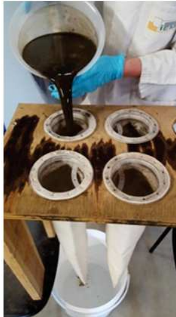
Figure II.6 – Filtration des boues activées du Bàm de La Grande-Motte
