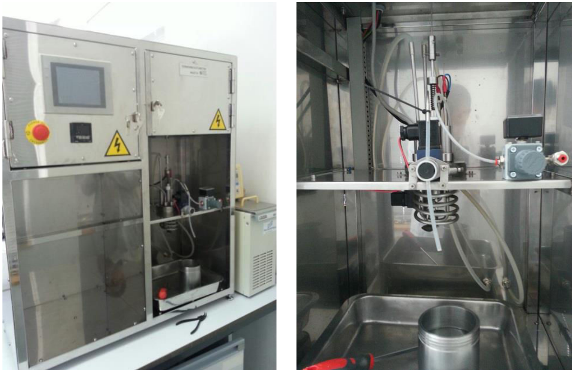
Figure IV - 1 : Thermorésistomètre Mastia® utilisé pour les études cinétiques
