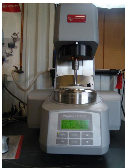
Figure IV - 8 : Photographie d'un rhéomètre Anton Paar MCR 301
