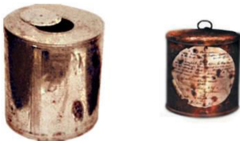
Figure II - 2 : Photographie des premières boîtes de conserve inventées en 1810 (boîte à trou à gauche et boîte à bouchon à droite) ( http://www.azaquar.com )
