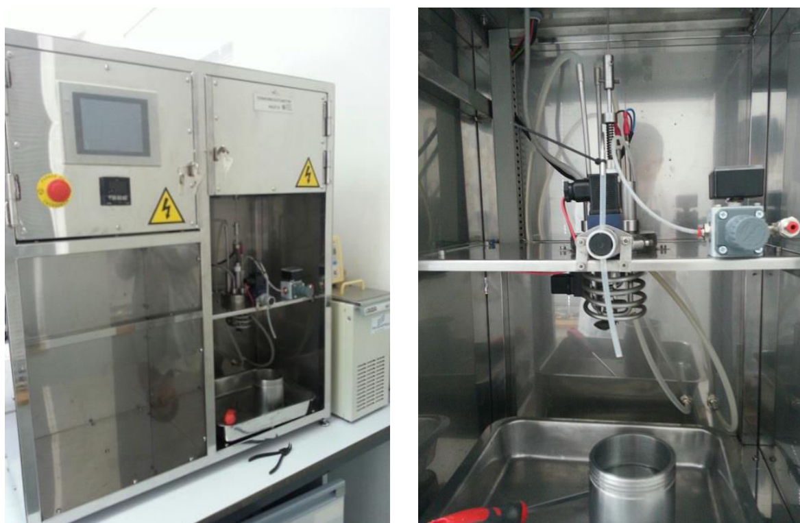
Figure IV - 1 : Thermorésistomètre Mastia® utilisé pour les études cinétiques
