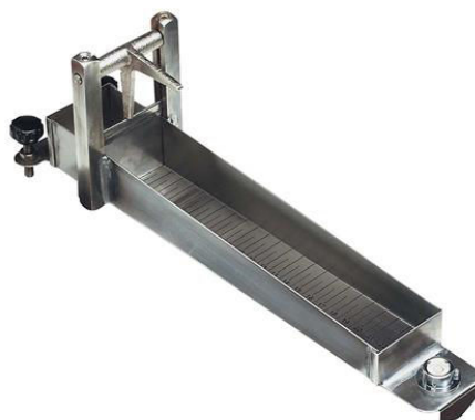
Figure IV - 3 : Consistomètre de Bostwick
