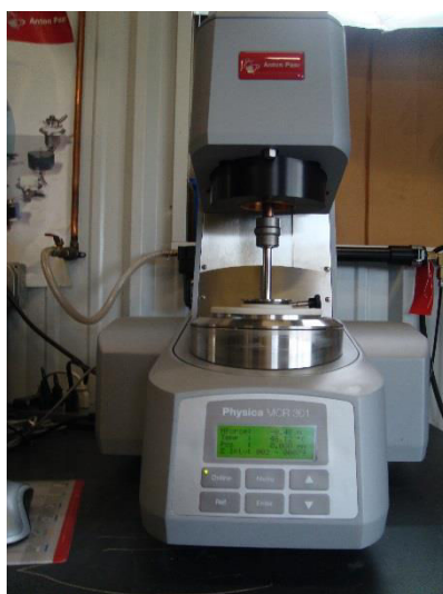
Figure IV - 8 : Photographie d'un rhéomètre Anton Paar MCR 301
