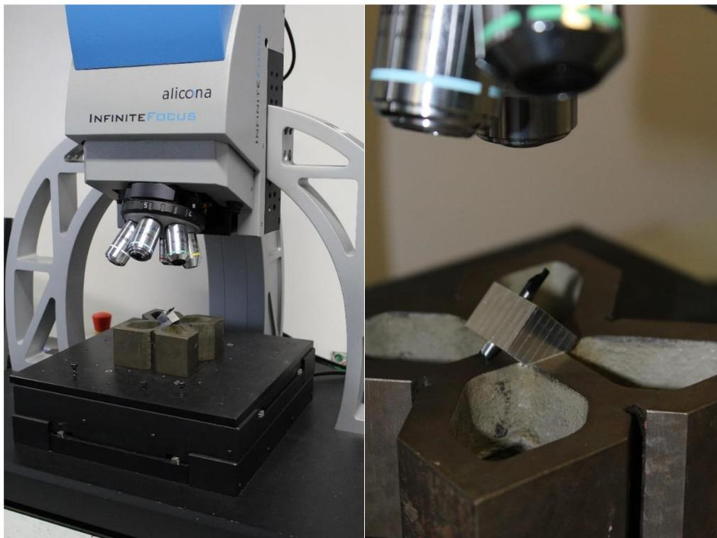
Figure 2-5 - Mesure des caractéristiques des outils avec Alicona IF
