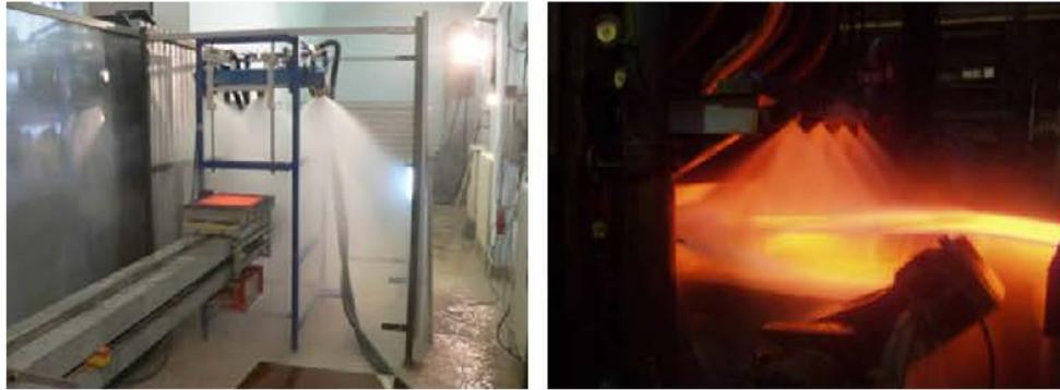
Figure 2 – Refroidissement par sprays de brames d’acier défilantes
