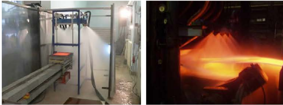
Figure 2 – Refroidissement par sprays de brames d’acier défilantes
