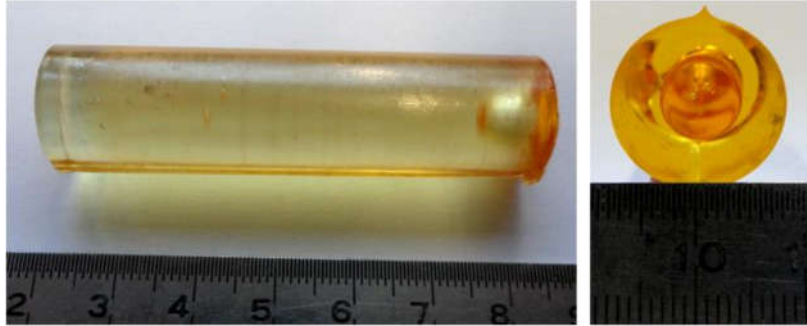
Figure V.21 : Photo d'une préforme de TZN-TZPb réalisée par BiC.
