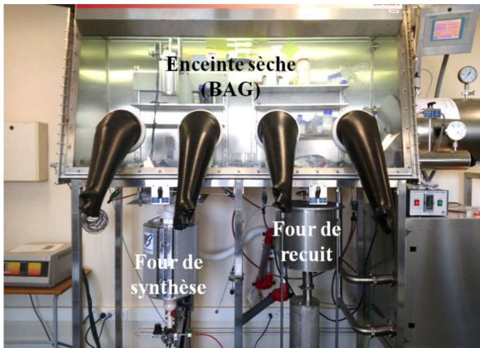
Figure III.11 : Photo du dispositif utilisé pour la synthèse de verre de tellurite en BAG.
