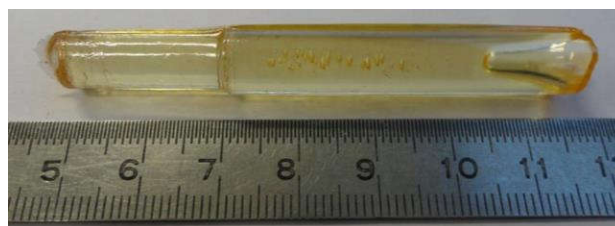
Figure III.19 : Préforme en verre de tellurite de 20 g fabriquée dans un moule de 8 mm de diamètre.
