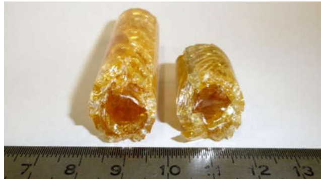
Figure V.7 : Echec de fabrication de préforme double-indice par built-in casting à cause d'un verre de cœur trop chaud.
