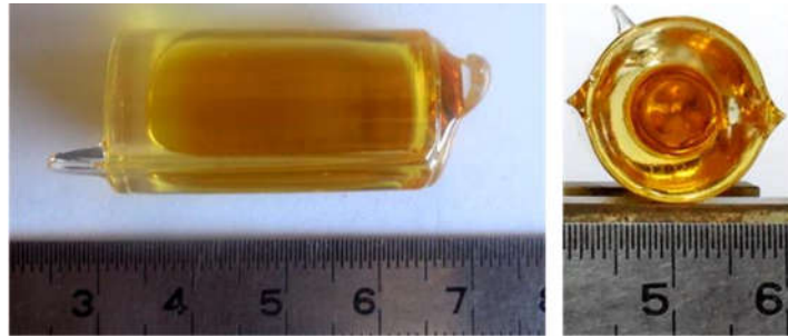
Figure V.10 : Photo d'une préforme de GPN-TWNb réalisée par BiC et recuite hors du moule utilisé pour la trempe.
