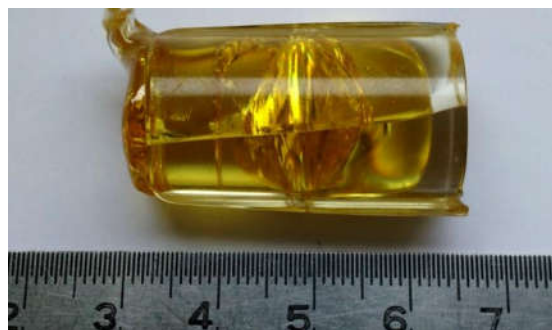
Figure V.9 : Préforme en GPN-TWNb fabriquée par BiC et fissurée après recuit.
