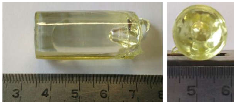
Figure V.17 : Photo d'une préforme de GPN-TBZ réalisée par BiC.
