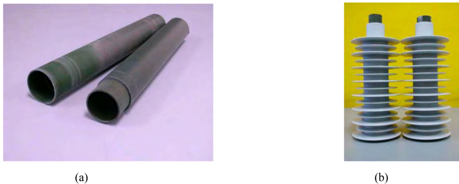
Figure I.19 - Prototype d'un nouveau câble de terminaison haute tension pour des tensions \geq 84 kV (b). La couche la plus interne (a) joue le rôle de la gradation de potentiel et se compose d'un composite chargé de microvaristances avec du silicone comme matrice [Greuter 2004]
