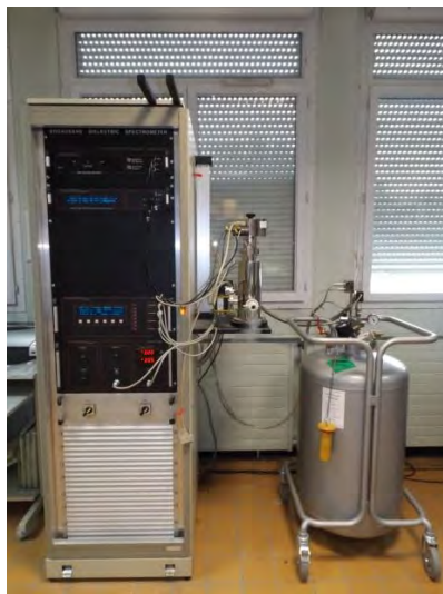
Figure A.1 - Novocontrol Alpha-A : Spectromètre diélectrique large bande
