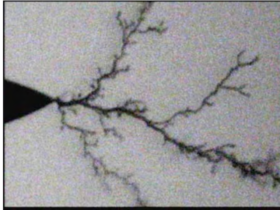
Figure I.7 - Photographie d'une arborescence autour d'une pointe sous tension impulsionnelle ( V=17 kV) dans un gel silicone [Do 2008]
