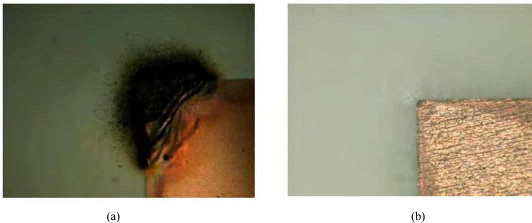
Figure I.14 - (a) Erosion causée par les décharges partielles suivies par la rupture pour l'époxy de référence sous 4,8 \text{ kV}_{\text{rms}} pendant 1,5 h. (b) Epoxy composite chargée à 5 wt.% en nanoparticules sous 4,8 \text{ kV}_{\text{rms}} pendant 2 h [Zhe 2011]
