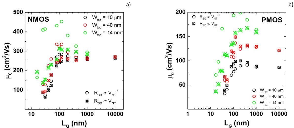
**Figure 3.34.:** Mobilité à champ nul  $\mu_0$  en fonction de la longueur de grille extraite à l'aide d'un ajustement direct en utilisant la fonction décrite par Ferdousi *et al.* [46] (voir texte) pour trois largeurs de canal et pour les dispositifs NMOS (a) et PMOS (b). Les résultats en fonction de l'expression de la résistance d'accès (variant avec  $V_{GT}$  symboles vides ou variant avec  $V_{GT}^{-1}$  symboles barrés) sont comparés.
