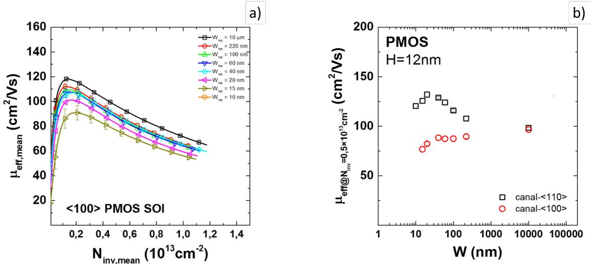
**Figure 3.19.:** a) Mobilité effective en fonction de la densité de porteurs en inversion des transistors orientés dans la direction  $\langle 100 \rangle$  pour différentes largeurs de canal :  $W_{top} = [10\mu\text{m} - 15\text{nm}]$ . b) Mobilité effective à  $N_{inv} = 0.5 \cdot 10^{13}\text{cm}^{-2}$  en fonction de la largeur de grille  $W_{top}$  et de l'orientation du canal :  $\langle 110 \rangle$  (carrés noirs) et  $\langle 100 \rangle$  (ronds rouges).
