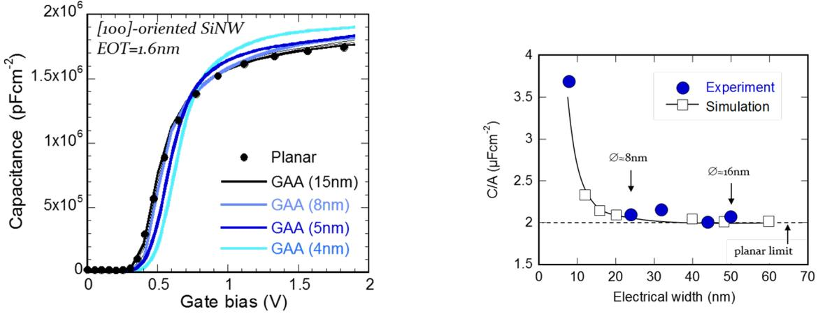
**Figure 2.7.:** Comparaison de la capacité  $C_{gc}$  entre des mesures expérimentales [6] et la simulation [10]. On voit que la capacité  $C_{gc}$  n'est en théorie pas modifiée par le confinement pour des nanofils larges ( $W_{top} > 10nm$ ). Les nanofils GAA de diamètre  $d$  ont une largeur efficace égale à  $W_{eff} = \pi d$ .
