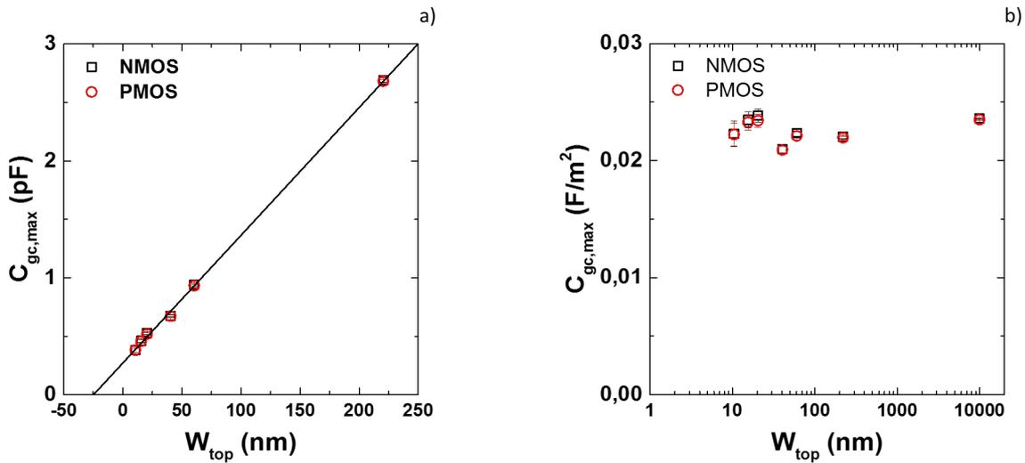
**Figure 2.8.:** a) Capacité maximale mesurée sur les dispositifs nanofils NMOS et PMOS en fonction de la largeur de grille  $W_{top}$ . b) Capacité maximale par unité de surface mesurée sur les mêmes dispositifs (normalisation par la surface  $S = W_{eff} \times L_G \times n_{canal}$ ).
