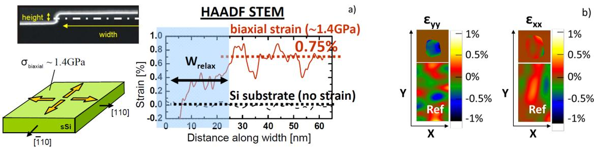
**Figure 2.11.:** (a) Profil de la déformation dans la section d'un transistor sSOI large obtenue par la technique HAADF, montrant une contrainte biaxiale en tension de  $\approx 1.4\text{GPa}$  dans le canal et une relaxation de celle-ci en bord de zone active. (b) Déformation mesurée dans la section d'un nanofil sSOI en échelle de couleurs dans la direction de la largeur ( $\epsilon_{xx}$ ) et dans la direction de la hauteur du nanofil ( $\epsilon_{yy}$ ).
