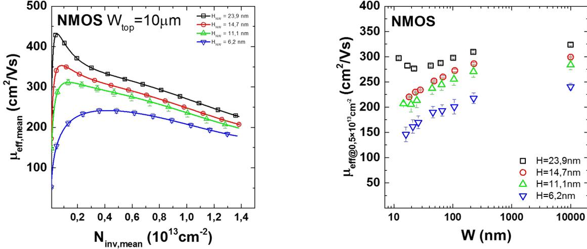
**Figure 3.5.:** a) Mobilité effective en fonction de la charge d'inversion mesurée pour des transistors NMOS planaires ( $W_{\text{NW}} = 10 \mu\text{m}$ ) et pour différentes épaisseurs de canal  $H_{\text{NW}} = [24 - 6] \text{nm}$ . b) Mobilité effective à  $N_{\text{inv}} = 0.5 \cdot 10^{13} \text{cm}^{-2}$  en fonction de la largeur  $w_{\text{top}}$  et de l'épaisseur du canal  $H$ .
