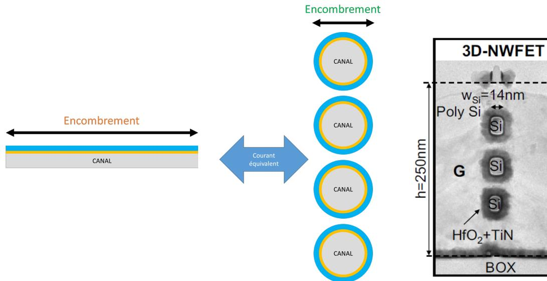
**Figure 1.8.:** (gauche) Schéma comparatif entre un design planaire et un design GAA empilé illustrant le gain en densité de transistors pour des nanofils empilés. (droite) Exemple d'une structure avec des nanofils empilés réalisée au Leti en 2008 sur substrat SOI (d'après [44]).
