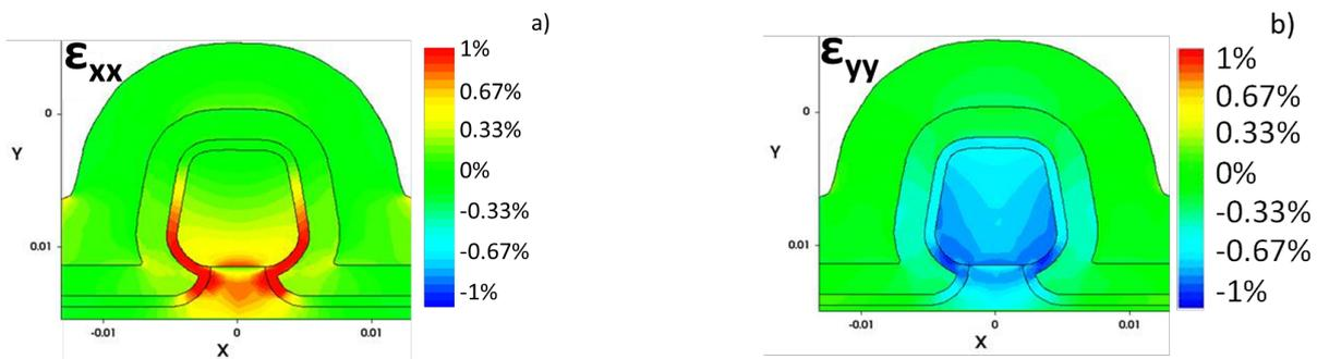
**Figure 2.12.:** Contraintes calculées par simulation mécanique dans la section d'un nanofil sSOI (même structure que la Fig. 2.11) : (a) dans la direction de la largeur ( $\epsilon_{xx}$ ), et (b) dans la direction de la hauteur du nanofil ( $\epsilon_{yy}$ ).
