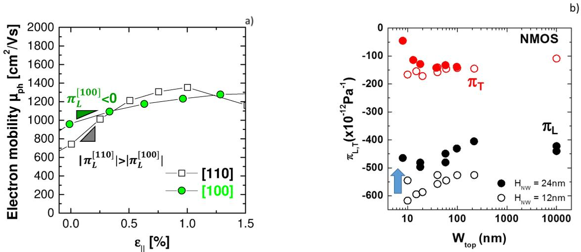
**Figure 4.8.:** a) Mobilité des électrons limitée par les phonons calculée en fonction d'une déformation uniaxiale  $\epsilon_{||}$  parallèle au transport dans un nanofil ( $d=8\text{nm}$ , d'après [81]). b) Évolution du coefficient piézorésistif avec la largeur des nanofils pour deux hauteurs de canal différentes  $H_{NW}=12\text{nm}$  et  $H_{NW}=24\text{nm}$  ( $L_G = 10\mu\text{m}$ ,  $N_{inv} = 0.8 \times 10^{13} \text{cm}^{-2}$ ).
