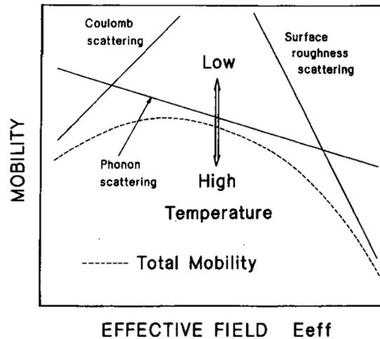
**Figure 3.3.:** Représentation schématique de la variation de la mobilité en fonction du champ effectif dans le canal des transistors, ainsi que des différents mécanismes de diffusion et l'effet de la température (d'après Takagi *et al.* [110]).
