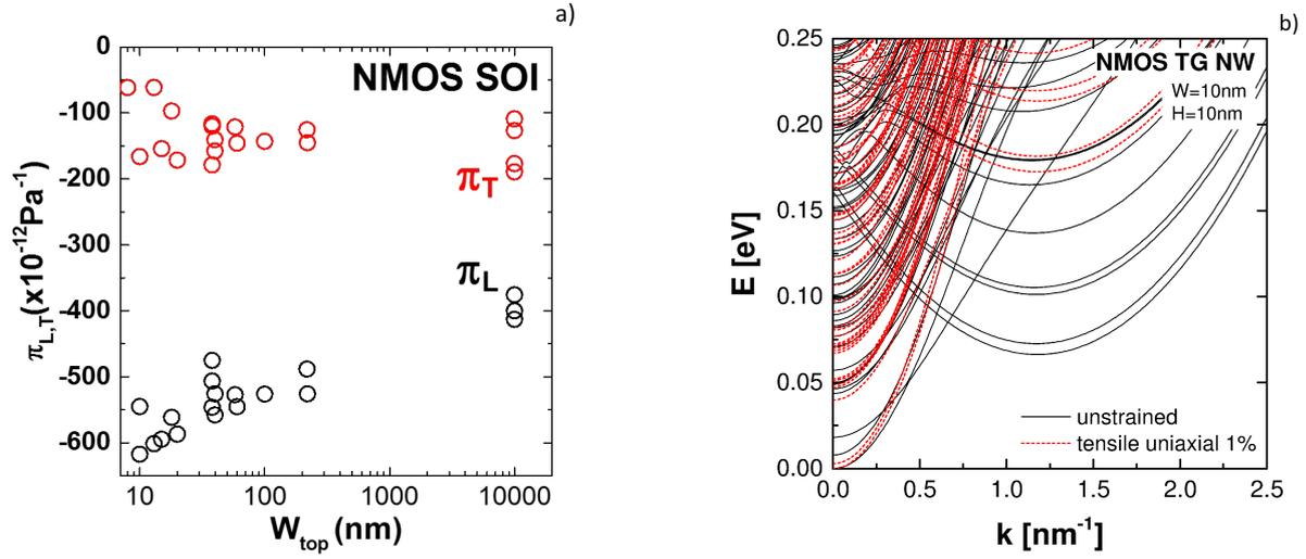
**Figure 4.6.:** a) Coefficient piézorésistif longitudinal (noir) et transversal (rouge) pour des dispositifs NMOS SOI avec une hauteur de canal de 12nm en fonction de la largeur de grille. b) Diagramme des bandes d'énergie  $E(k)$  calculé pour un transistor nanofil NMOS TriGate orienté selon  $\langle 110 \rangle$  non contraint et avec une contrainte uniaxiale tensile dans la direction du transport ( $W \times H=10\text{nm} \times 10\text{nm}$ ).
