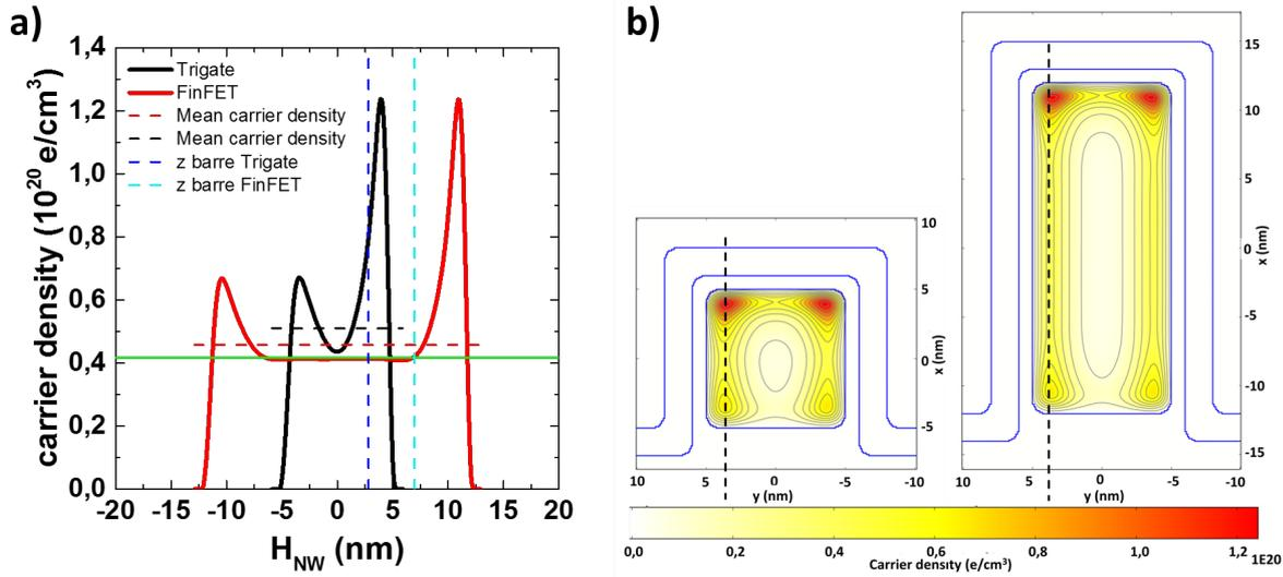
**Figure 3.28.:** a) Répartition des porteurs sur le flanc en fonction de la hauteur  $H_{NW}$  pour les plans de coupe en pointillés sur la figure b). b) Simulation 2D Poisson Schrödinger de la répartition des porteurs au sein d'un transistor triple-grilles pour deux hauteurs de canal : 10nm et 24nm.
