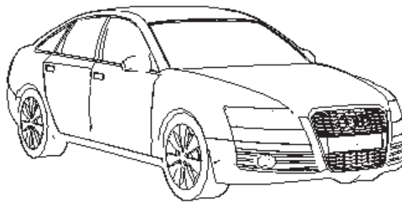
FIGURE 4.3 – Exemple d'un rendu contours d'un modèle 3D de véhicule (dans cet exemple, il s'agit d'une Audi A6).
