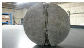
(b) Éprouvette fissurée en BF2.
