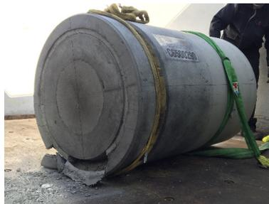
FIGURE 3.39: Fissuration du colis localisée au niveau de l'impact.
