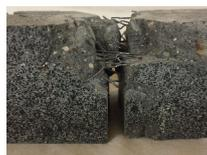
FIGURE 2.37: Faciès d'éprouvettes de flexion rompues de BF2.
