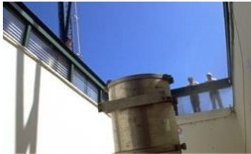
FIGURE 6: Essai de chute de colis [AREVA, 2016].
