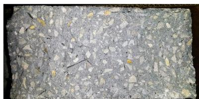
(a) Une moitié de l'éprouvette en BF1 rompue en deux.
