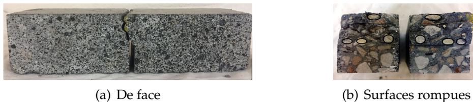
FIGURE 2.36: Faciès d'éprouvettes de flexion rompues de BF1.
