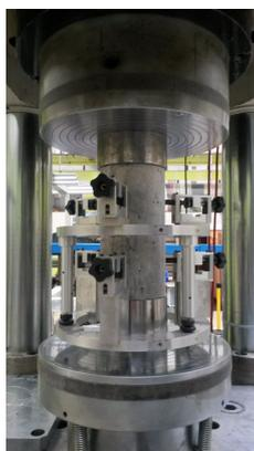
FIGURE 2.4: L'extensomètre pour le suivi des déformations longitudinales lors d'un essai de compression.
