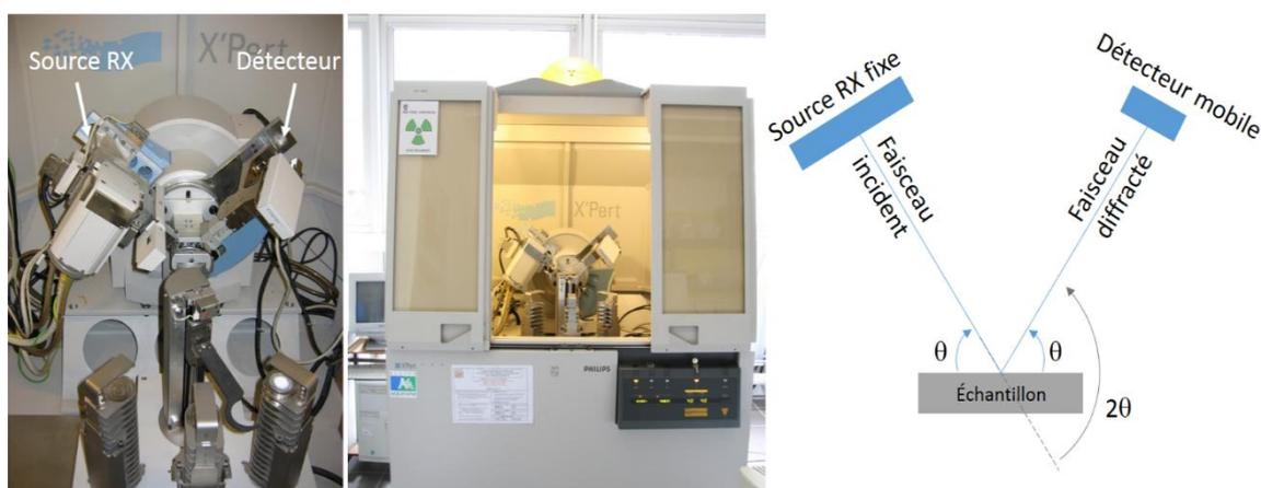
Figure 18 : Diffractomètre PANalytical X'pert PRO MPD et montage en configuration  $\theta$ - $2\theta$ .
