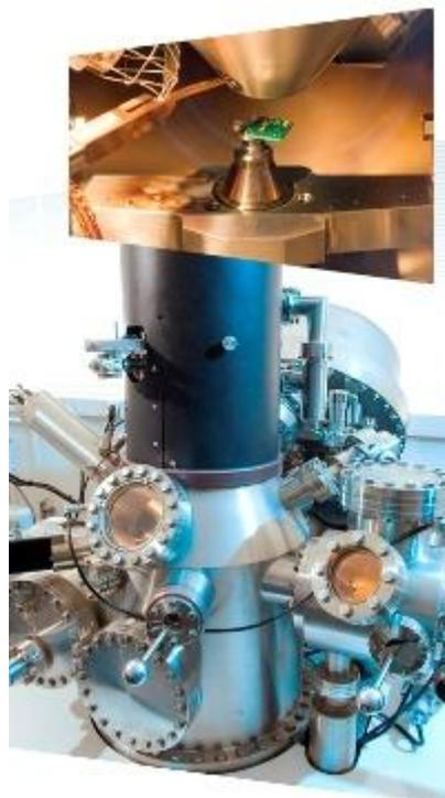
Figure 17 : Nanosonde AUGER VG Microlab 310F.
