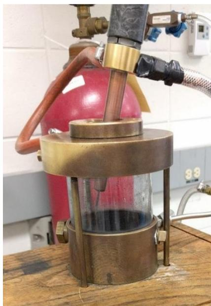
Figure 12 : Four à arc électrique de l'IRH.
