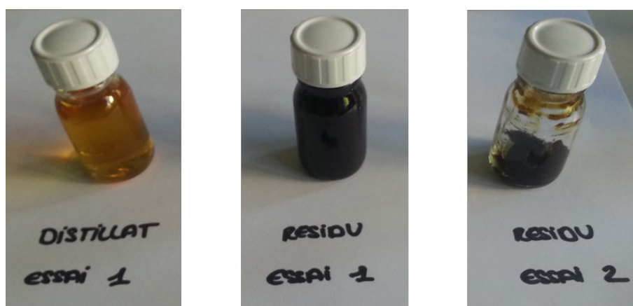
Figure 29 : Essais de décoloration par distillation moléculaire sur le pilote 1 Essai 1 : distillat et résidu ; Essai 2 : résidu
