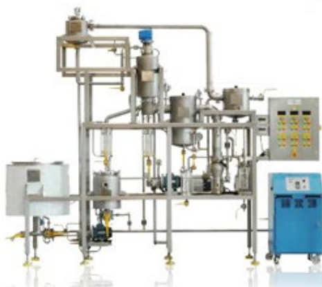
Figure 44 : Exemple d'unité de distillation moléculaire de type KDL-5 (Tournaire SA) 114
