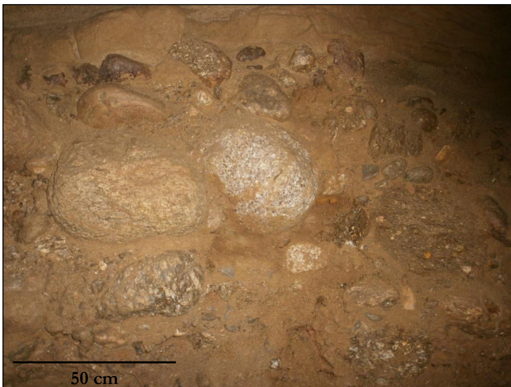
Point de prélèvement d'ASAR001_006 à ASAR001_009, chaque échantillon étant un galet du dépôt. La matrice, non analysée, est constituée de sables fins à moyens. Les galets sont majoritairement des granites, des gneiss et des quartzites. Les échantillons ont été datés via les nucléides cosmogéniques. Photo R. Braucher.
