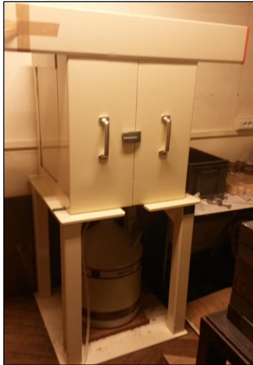
Figure 4-13 : Spectromètre gamma. Il comporte une sonde Ge haute pureté, et de faible bruit de fond.
