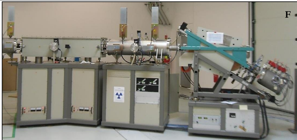
Figure 3-24 : A – Photographie panoramique de l'AMS ASTER (photographie G. Aumaître). La ligne d'injection comprend la source et l'aimant d'injection. L'accélérateur est au centre de l'AMS. La ligne d'analyse comprend tout l'appareillage en sortie d'accélérateur ; B – Carousel
