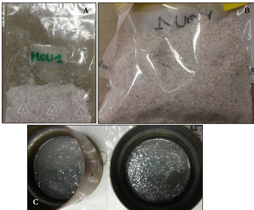
Figure 3-16 : A – Exemple d’un échantillon de la grotte des Moutons en Ariège, comportant encore environ 3% de muscovites à l’issue des trois lessivages à l’HF ; B – Le même échantillon après un passage au Frantz à forte intensité, puis un tamisage, ne contient que quelques paillettes de muscovites pouvant être aisément retirée à la pince ; C – La fraction 100-250 \mu\text{m} (à droite) recèle davantage de muscovites que la fraction supérieure à 250 \mu\text{m} (à gauche).
