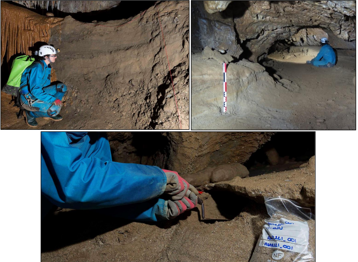
Figure 4-5 : Exemples de zones de prélèvements pour analyses RPE. En haut à gauche : coupe de sédiments sablo-limoneux bordant le drain actif de la grotte du TM 71 (Fontanès-de-Sault, Aude, photo P. Moreno). En haut à droite : coupe de sédiments sablo-limoneux de la galerie de la grotte de Fer, pour prélèvement « mixte » RPE – cosmogéniques, grotte d'En Gorner (Villefranche-de-Conflent, Pyrénées-Orientales, photo G. Hez). En bas : prélèvement « mixte » RPE – cosmogéniques de sables alluviaux exogènes piégés sous un plancher stalagmitique, dans la galerie des Fleurs de la grotte de l'Aguzou (Fontanès-de-Sault, Aude, photo P. Moreno).
