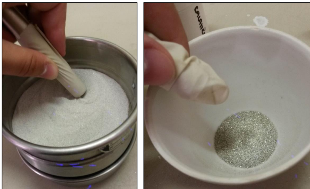
Figure 2 : Tri magnétique à l'aimant de l'échantillon d'une grotte du massif de Calamès (à gauche), afin d'éliminer les minéraux paramagnétiques (et sensibles à l'électricité statique) tels que les micas (à droite)
