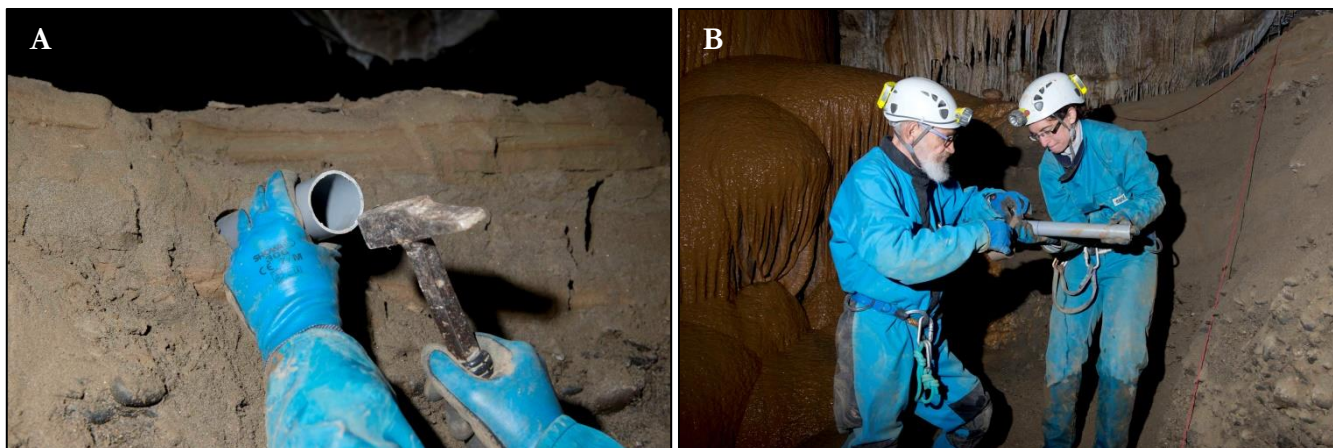
Figure 4-15 : A – Exemple de prélèvement OSL. Le prélèvement s'effectue dans le noir, seul le flash de l'appareil photo est venu perturber quelques instants la manipulation. B – Le tube est immédiatement obturé dès la sortie du trou, toujours dans l'obscurité. Photos P. Moreno.
