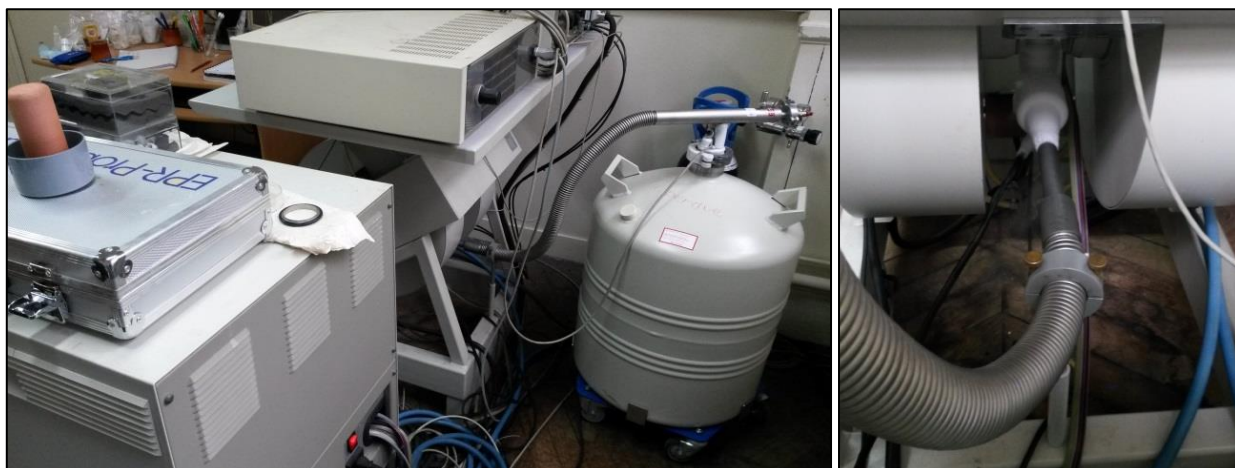
Figure 11 : Face arrière du spectromètre. Le flexible de la canne alimente la cellule
