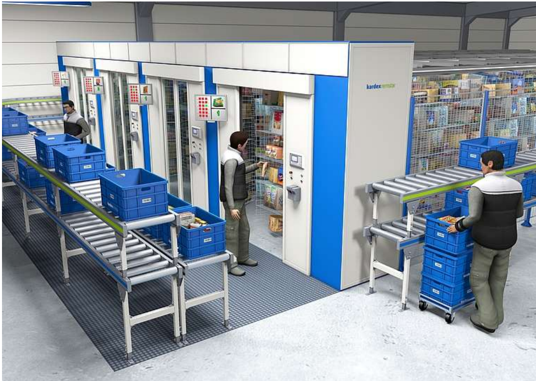
Figure 36 : Illustration d'un système "Drive" (source : www.kardex-remstar.be )
