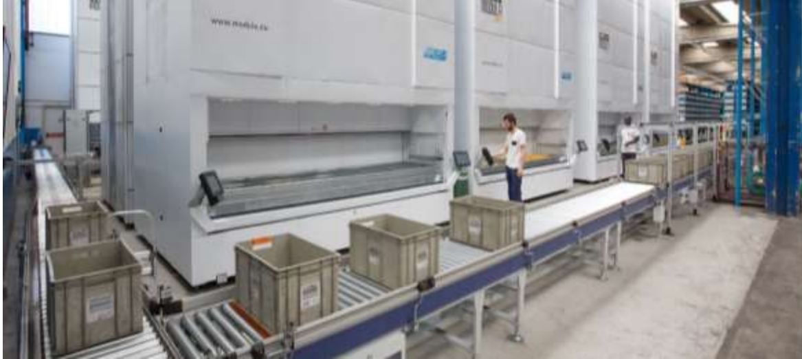
Figure 18 : Préparation de commandes avec regroupement en lots et utilisation de VLMs
