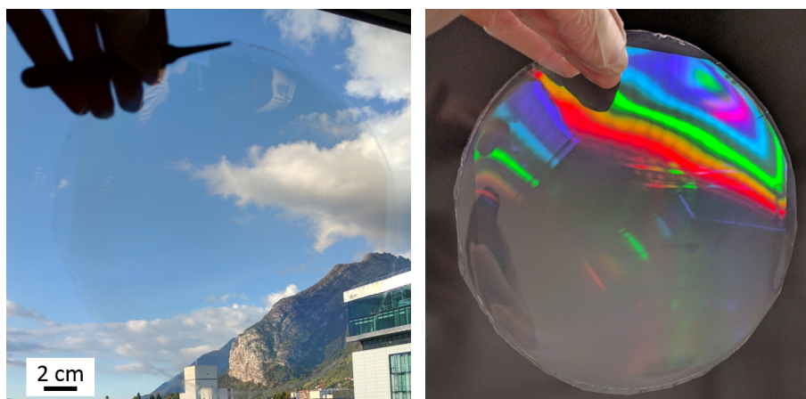
FIGURE 2.20 – Photographies d’un film flexible, transparent et superhydrophobe obtenu grâce au protocole de la Figure 2.19.
