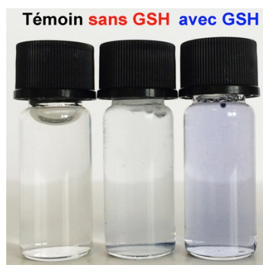
Figure 93. Couleurs du milieu réactionnel observées à l'issue de la transformation enzymatique de la (+)-catéchine avec et sans GSH.
