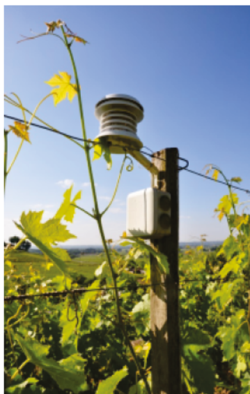
Figure 46: Capteur de température Tinytag sous abris anti-radiation installé dans la canopée dans un vignoble de la région de Saint-Émilion
