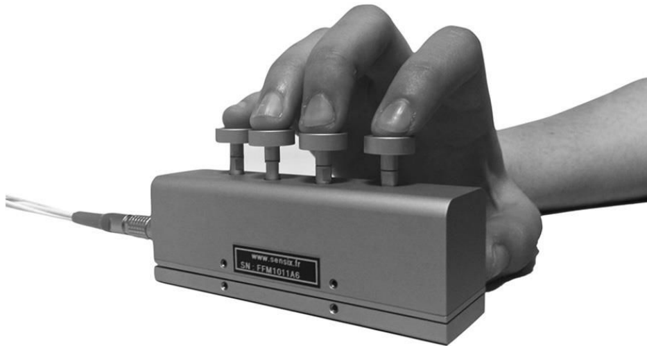
Figure 9 : Finger Force Manipulandum . Photo de la main d'un sujet en position d'utilisation posée sur une surface. Chaque doigt est positionné sur un piston distinct. L'appareil est relié à un CED (hors champ) par une connectique.
