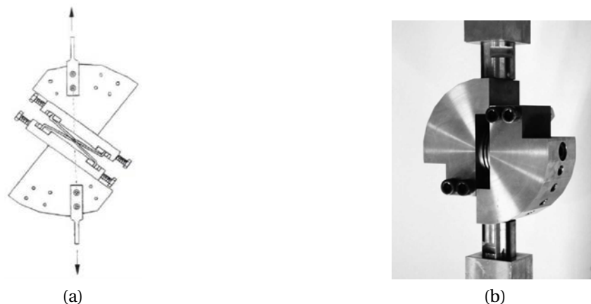
FIGURE 2.7 – Essais de caractérisation de type Arcan : (a) Montage Arcan proposé par Lee et al. [Lee et al., 1998], (b) Montage Arcan proposé par Langrand et al. [Langrand et al., 2003]
