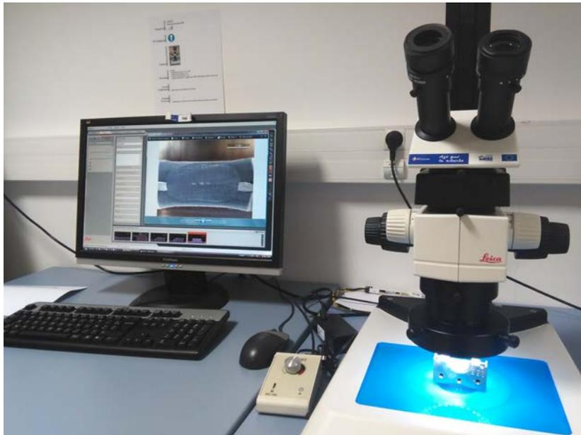
FIGURE 4.7 – Caméra microscopique LEICA IC80 HD
